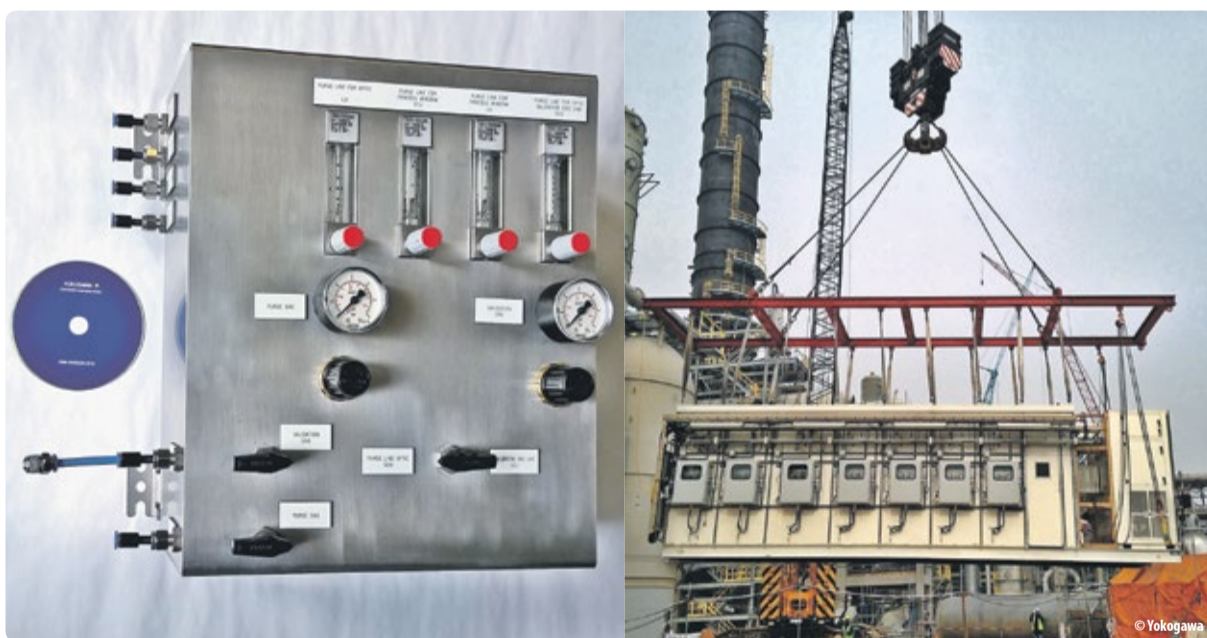
PAT in jeder Größe – vom kompakten Steam and Water Analysis System (SWAS)-Panel (links) bis zum Raffinerie-Analysencontainer mit 15 Prozess-GC (rechts).
