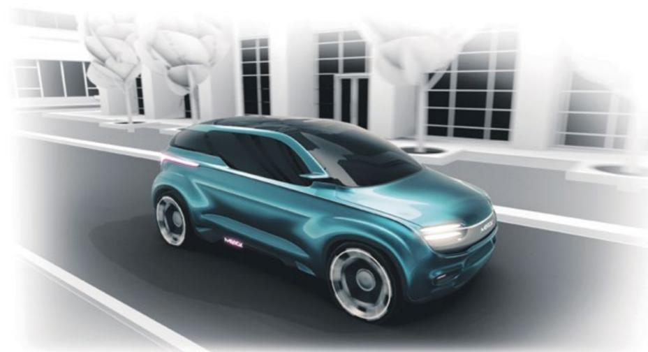
in der Automobilbranche für schaltbare Panoramadächer. Eine Nutzung für Seiten- und Heckfenster ist auch angedacht. Durch die spezielle Flüssigkristallmischung in den Scheiben lassen sich diese sekundenschnell
