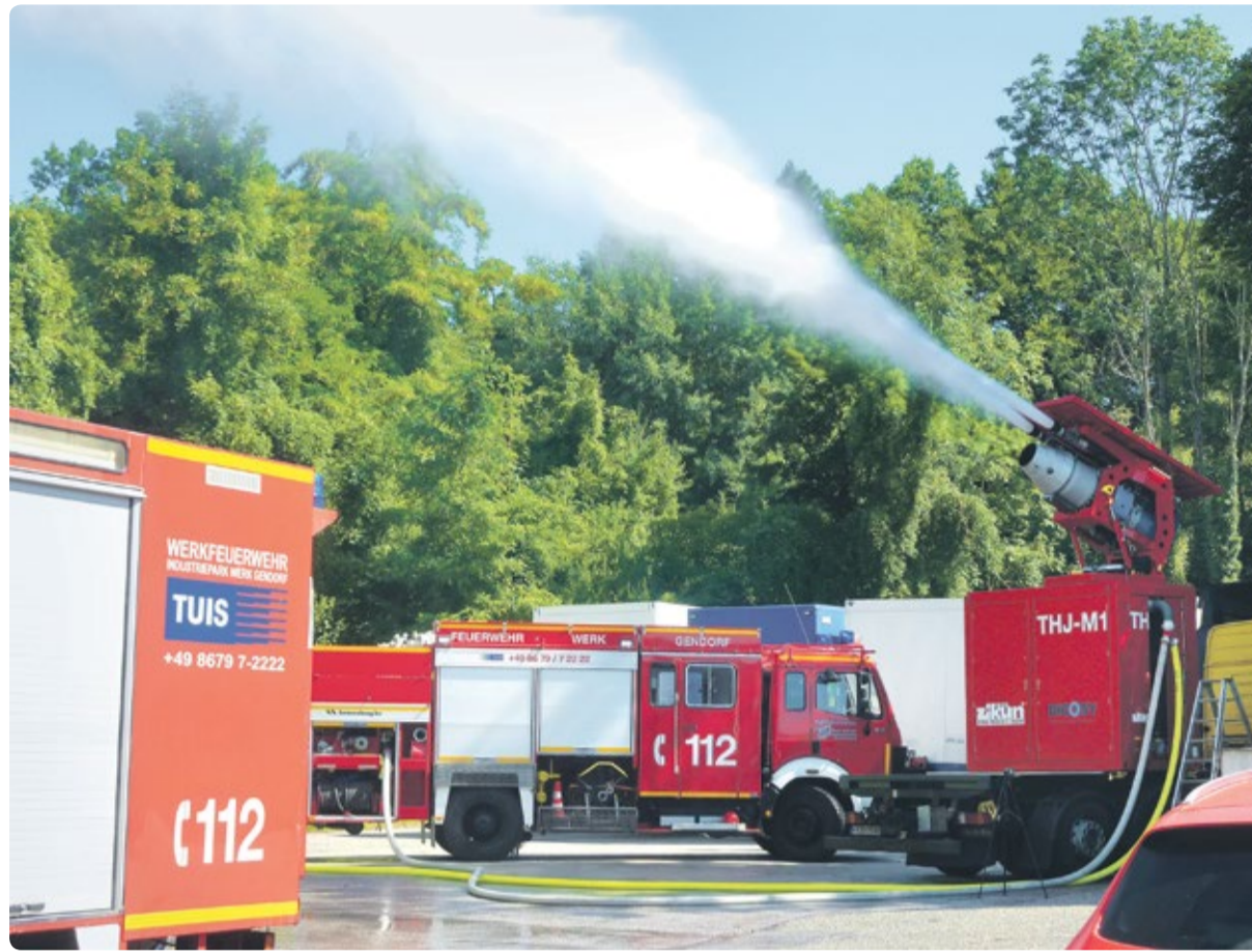
Im Chemiapark Gendorf setzt man auf das Turbolöschsystem. Gelöscht wird mit Hochdruckwassernebel statt mit einem Wasserstrahl.
