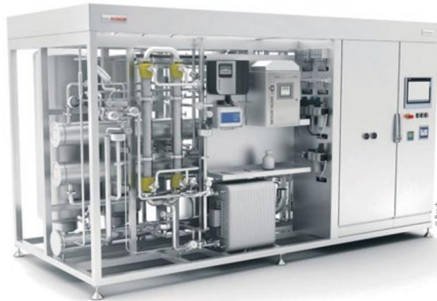
In der Anlage von Bosch zur Erzeugung von Wasser für Injektionszwecke (WFI) kommen die Membranverfahren Umkehrosmose und Elektrodeionisation mit einer zusätzlichen Ultrafiltrationsstufe zum Einsatz
