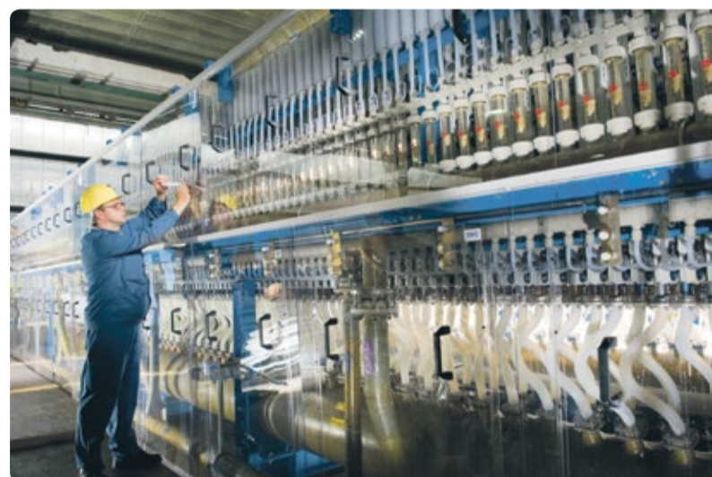
Covestro-Mitarbeiter Michael Kesselheim an der Pilotanlage für die Chlorproduktion in Krefeld-Uerdingen. Ein Teilstrom des salzhaltigen Abwassers aus der NaCl-Recyclinganlage wird gereinigt und als Rohstoff in der Chlorelektrolyse eingesetzt.
