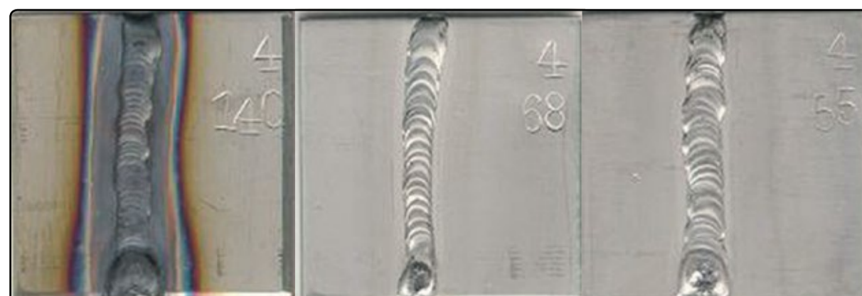
Abb. 2: Bleche mit aufgesetzter Schweißnaht biologisch (4/68) bzw. mit ANTOX (4/55) gereinigt.
