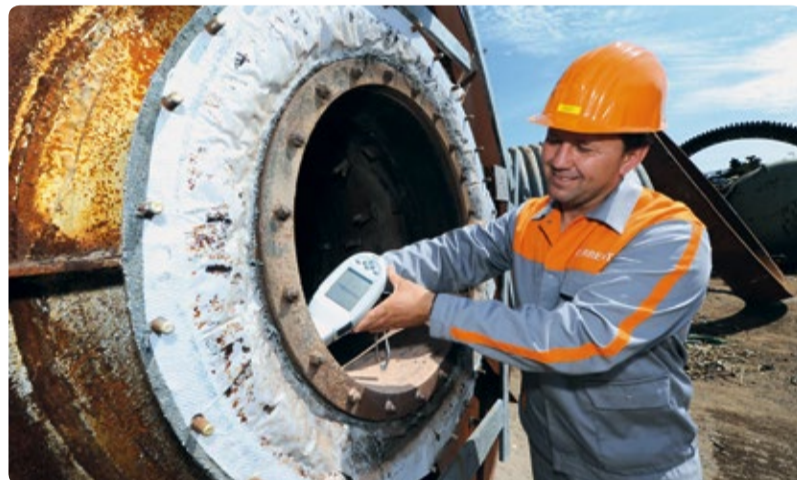
Schrott wird auf seine Metallzusammensetzung analysiert und entsprechend sortiert.
