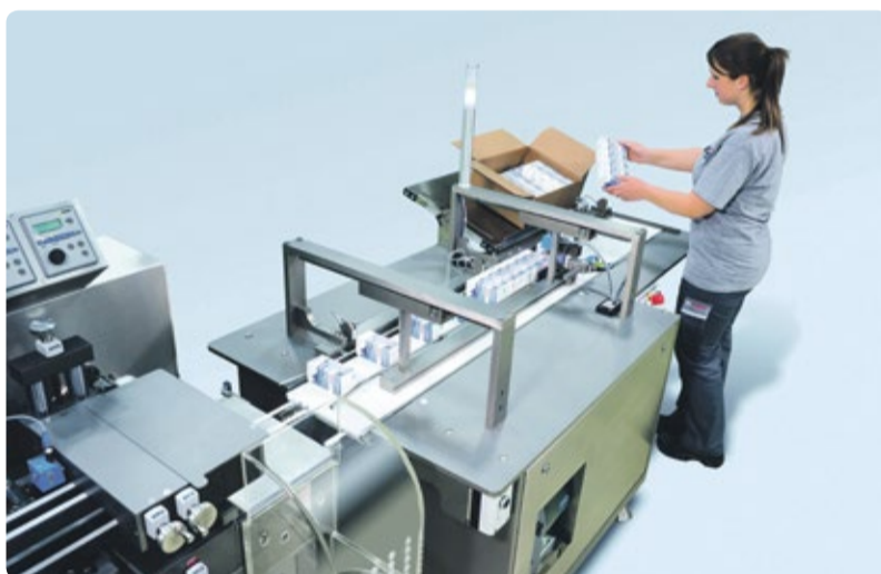
Die semi-automatische Aggregationslösung der CPS 0400 ermöglicht es auf einfachste Weise, Faltschachteln sicher in einen Umkarton zu verpacken.
