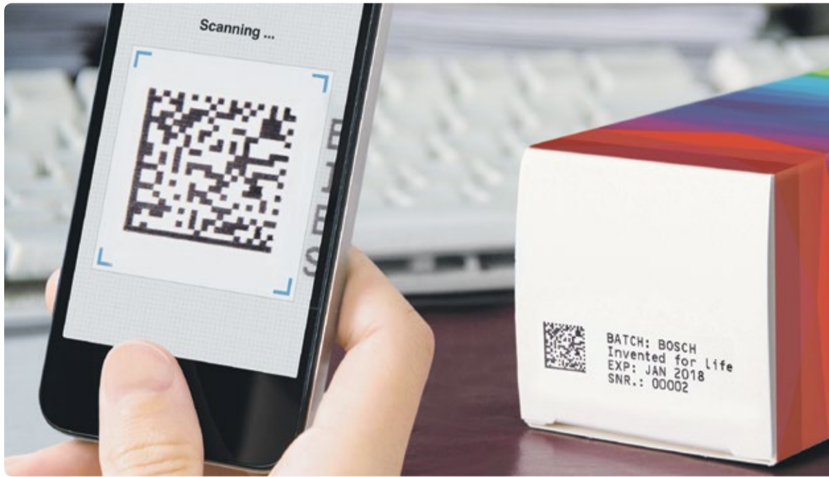
Der 2D Data Matrix Code enthält neben einer randomisierte Serialisierungsnummer die Chargennummer, das Verfallsdatum sowie weitere Daten nach Bedarf.
