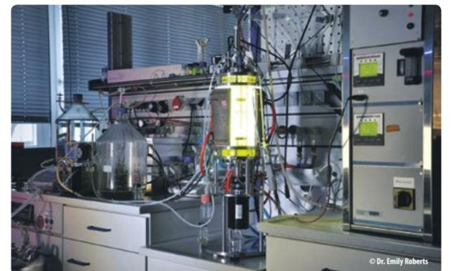
chen. Zur Kontrolle des Messwertes entschied sich das KIT-Forschungsteam für den Polylite Plus pH-Sensor mit der Single Pore Technologie in der Arc-Version. Der stabile Referenzelektrolyt Polysolve Plus trägt maßgeblich zur Langlebigkeit des Sensors bei. Die direkte Anbindung
