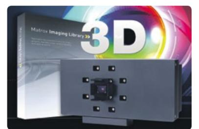
Die Low-Cost 3D-Kamera (640x480 Pixel) liefert 2D und 3D Daten gleichzeitig in einer Aufnahme damit die Höhen- und Grauwertinformation parallel ausgewertet werden können. Die ToF-Kamera wird komplett mit Optik und Beleuchtung, kalibriert auf ca.  $\pm 1$  cm Genauigkeit, ausgeliefert und eignet sich für Anwendungen in Automation, Logistik, Robotik, Medizintechnik und für autonome Fahrzeuge.
