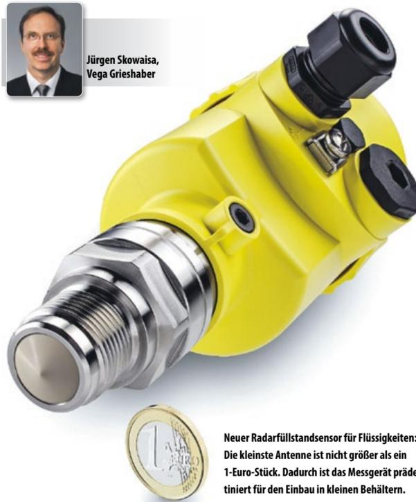
Neuer Radarfüllstandsensor für Flüssigkeiten: Die kleinste Antenne ist nicht größer als ein 1-Euro-Stück. Dadurch ist das Messgerät prädestiniert für den Einbau in kleinen Behältern.
