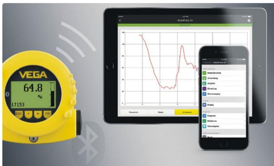
Das Anzeige- und Bedienmodul Plicscom mit Bluetooth ermöglicht eine drahtlose Inbetriebnahme, Messwertanzeige und Sensordiagnose per Smartphone oder Tablet.
