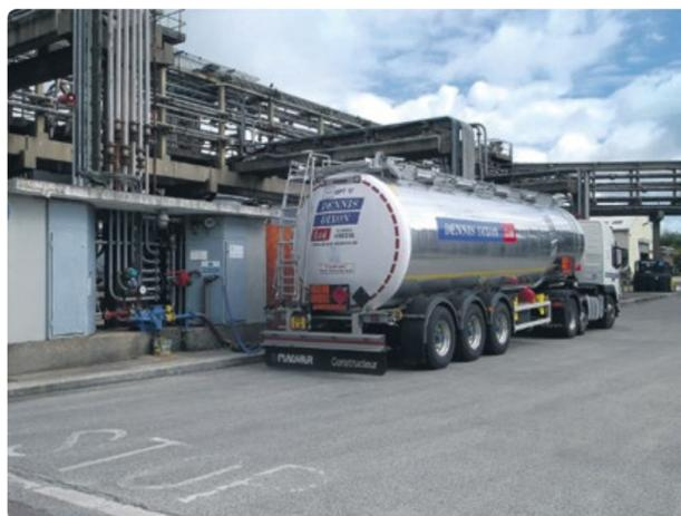
Das neue System ist so konzipiert, dass bei Pumpvorgängen in einem Tank alle Tanks gleichzeitig überwacht werden. So wird gewährleistet, dass keine Leckagen auftreten.
