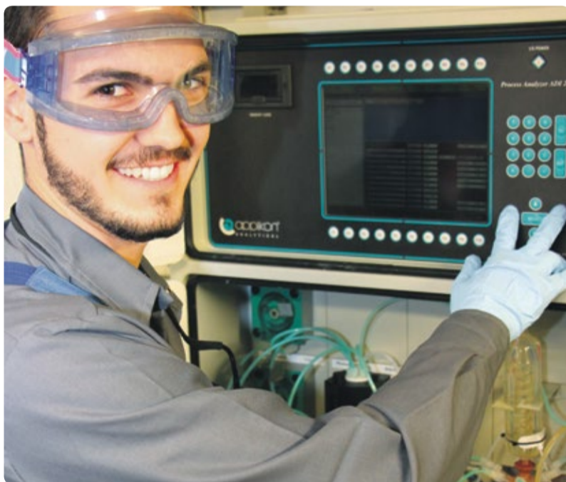
Güney Cabuk überwacht am Metrum-Analysator den Phosphatgehalt im Abwasser der Abwasserreinigungsanlage.
