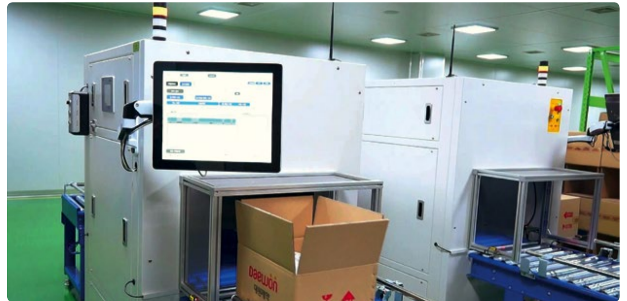
Die RFID Bulk Reading Machine kann in einer Bulk-Lesung bis zu 500 einzelne Datenträger in den Kartons identifizieren und ist zum Einsatz an Förderbändern geeignet. Insgesamt zehn RFID-Antennen erfassen den Inhalt der Kartons.
