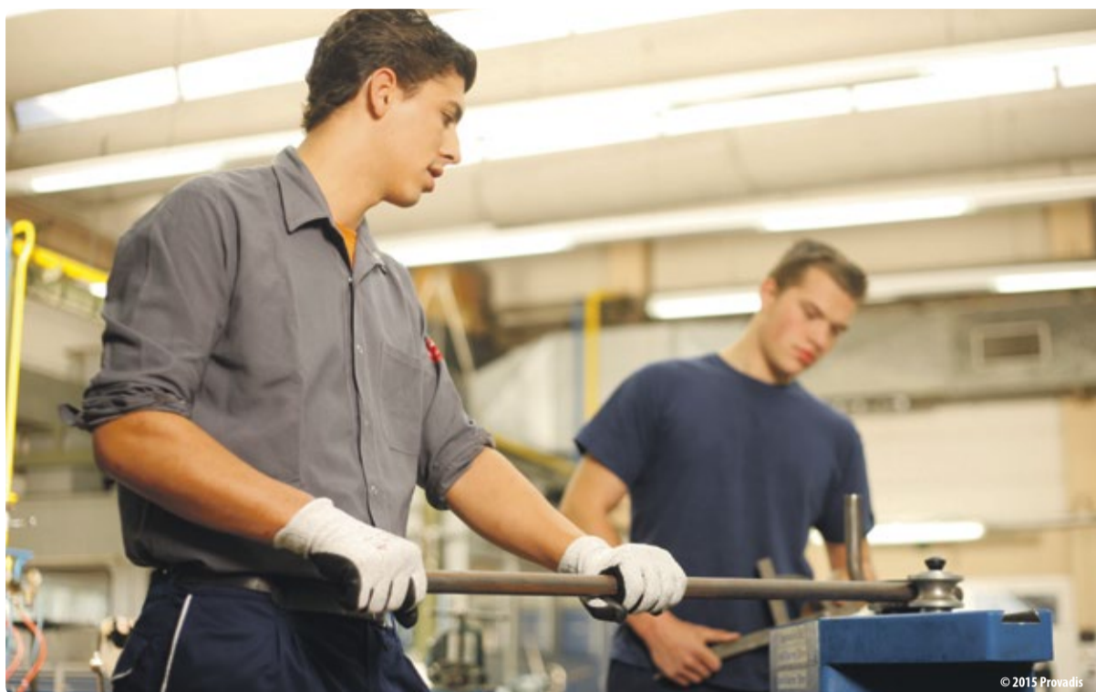
Auszubildende der Industriemechanik beim fachgemäßen Rohrbiegen in der Lehrwerkstatt.
