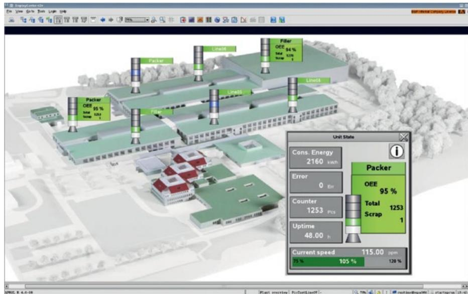
Die B&R-Automatisierungsplattform Apról deckt mit einem einfach zu bedienenden System Fabrikautomatisierung, Prozessautomatisierung und Infrastrukturautomatisierung ab.
