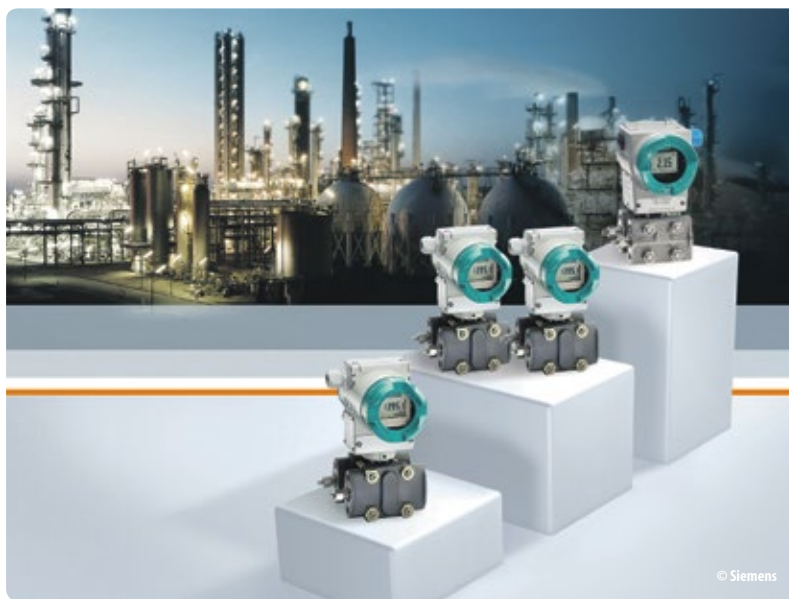
Die Sitrans Messumformer, die mit ihrer hohen Messgenauigkeit von bis zu 0,04 Prozent in Kombination mit Messblenden vor allem für Durchflussmessungen beim Befüllen und Entleeren von Gasspeichern geeignet sind, lassen sich problemlos in die „Digitale Fabrik“ integrieren.
