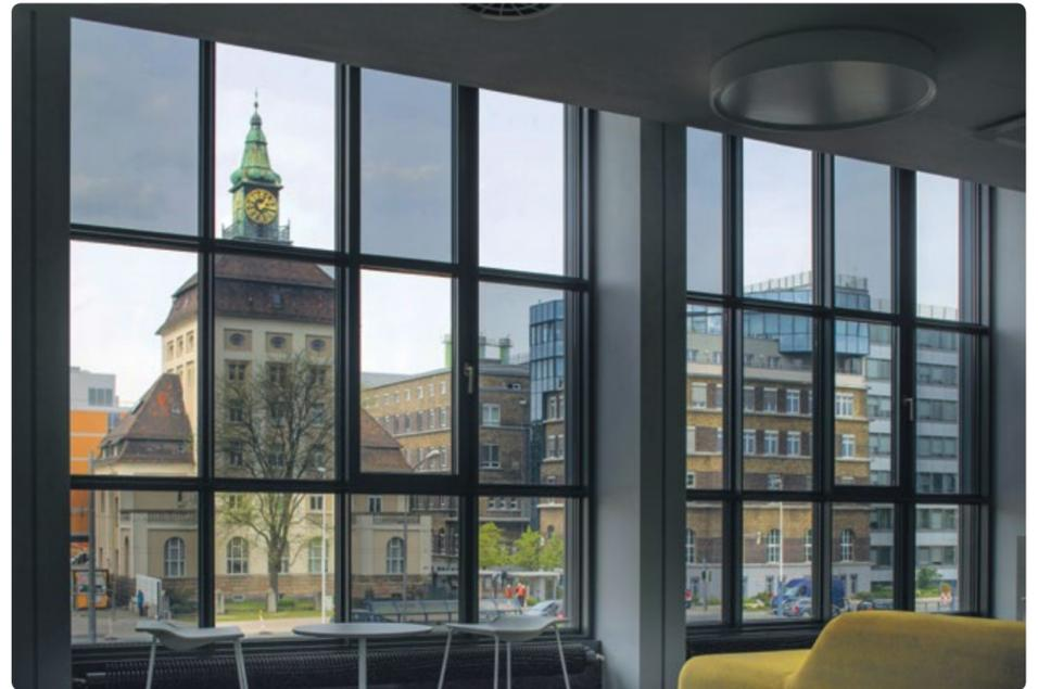
Flüssigkristallfenster, wie die im modularen Innovationszentrum von Merck in Darmstadt, sind schaltbare Glasscheiben, die die Lichtdurchlässigkeit verändern und so die Durchleitung von Licht und Wärme regulieren können. So ist es bspw. möglich, vorprogrammierte Sequenzen, z. B. ein Schachbrettmuster, darzustellen.
