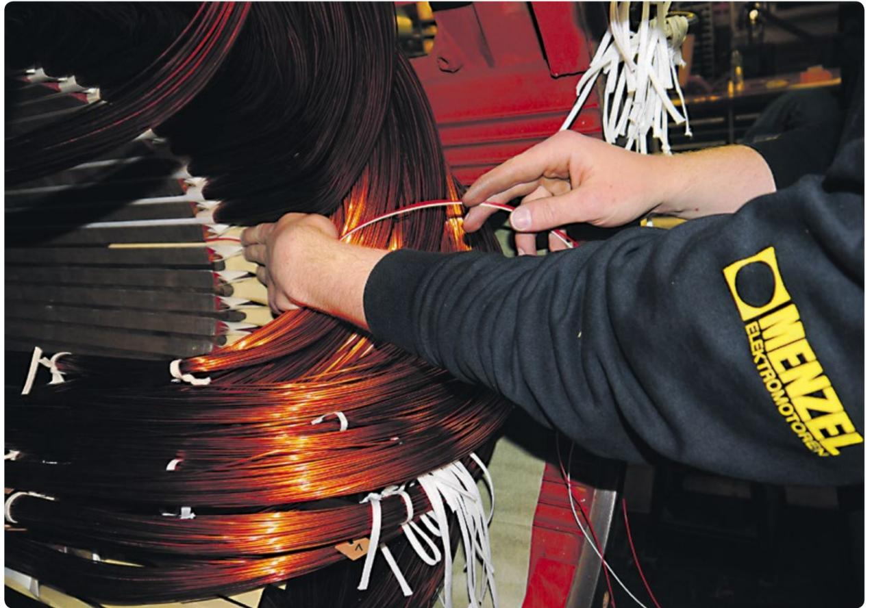
Einbau eines Nutenthermometers
