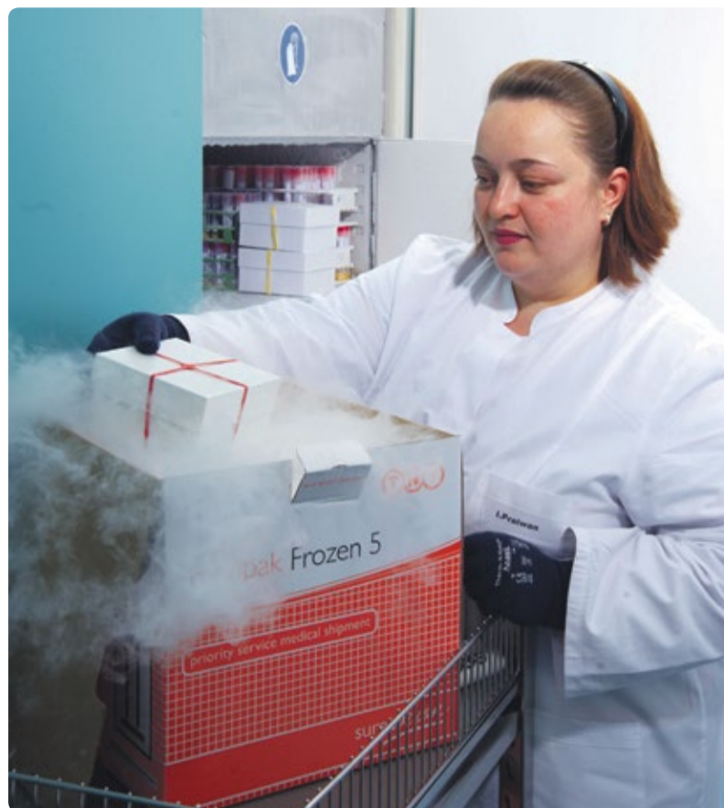
Die mit Trockeneis gekühlten Verpackungen halten die vorgeschriebene Transporttemperatur bis zu 96 Stunden lang.
