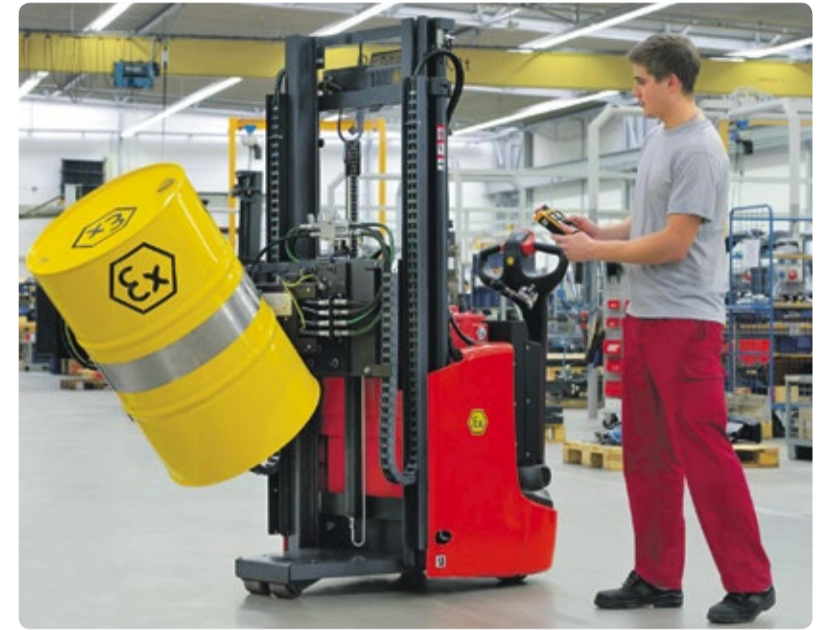
Mit Hilfe der speziellen Kundenlösung des ex-geschützten Fasskippers lassen sich offene Fässer greifen sowie bestimmte Mengen auf einer Waage dosieren und abfüllen. Foto: Linde Material Handling
