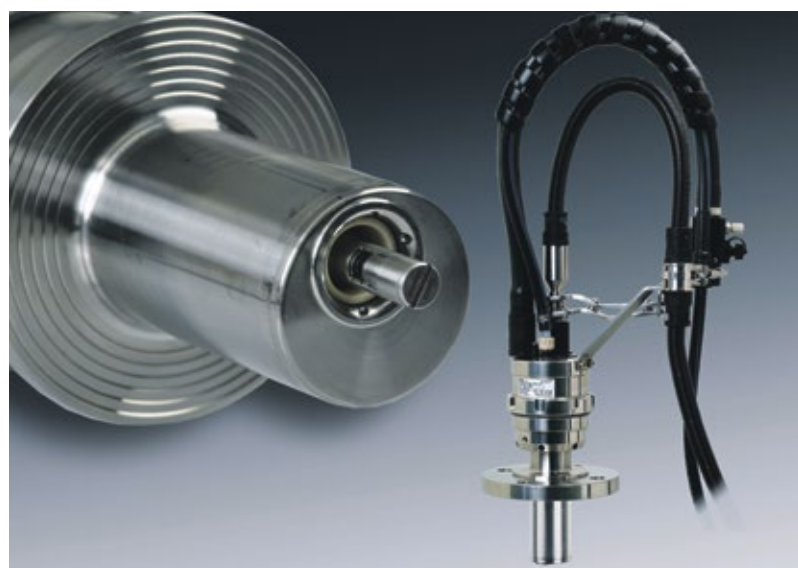
▲ Durch ihre praktisch unzerstörbaren Keramikelemente und ein nicht bewegtes Außengehäuse eignet sich die Wechselarmatur für den Einsatz in aggressiven oder abrasiven Medien sowie für Medien, die starke Ablagerungen bilden.
