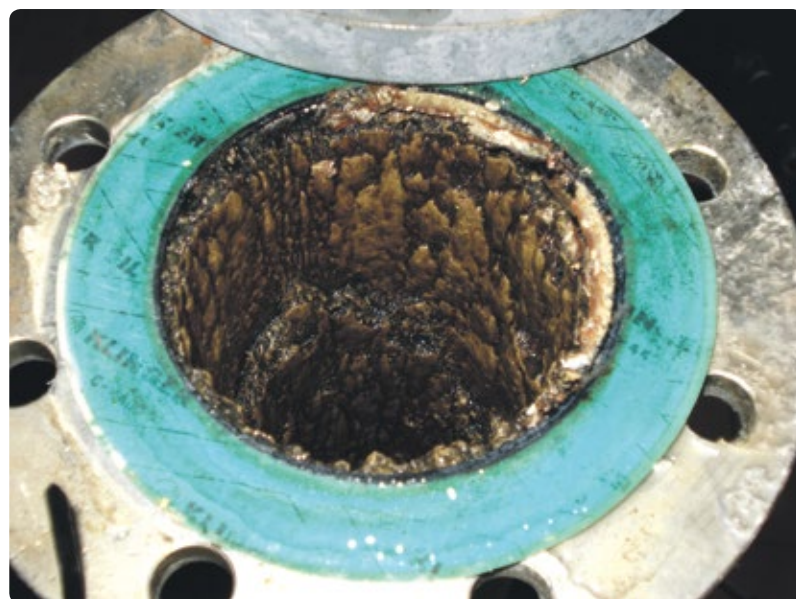
Produktansatz an Feldmessgeräten kann zu großen Messfehlern oder zum Ausfall des Messsignals führen.
