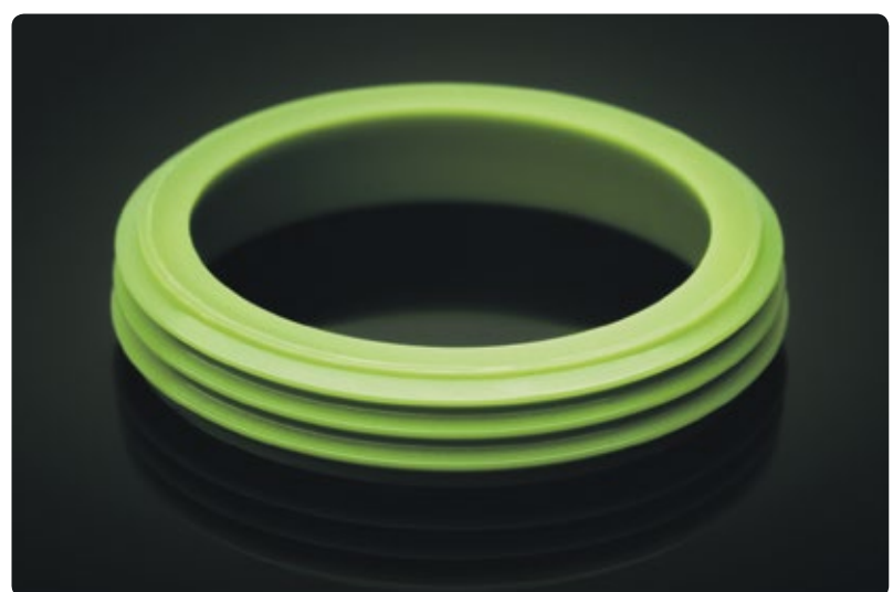
Im Motor-Kühlkreislauf werden Dichtungen für Kühlmittelkühler, Kühlmittelpumpe, Thermostat und Kühlmittelausgleichsbehälter benötigt. Dichtungen aus Elastosil LR 3022/60 bleiben im Kontakt mit heißen Kühlmitteln auch bei Dauerbelastung elastisch und dicht.
