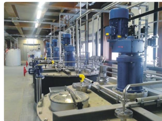
Radarsensoren Vegapuls 62 erfassen den Füllstand in den Ansatzgefäßen der Kieselsol-Anlage bei CWK.
