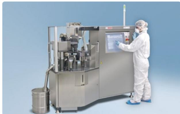
Die KXX 3900 von Bosch prüft Prozessqualitätsparameter wie Gewicht, Länge und Zustand der befüllten Kapseln gleichzeitig
