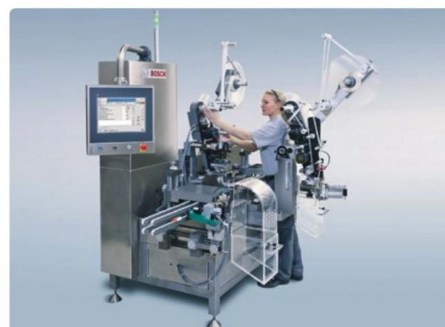
Das modulare CPS (Carton Printing System) von Bosch mit Tamper-Evident-Modul erfüllt alle Anforderungen einer Kombination aus Serialisierung, Nachverfolgbarkeit und Authentifizierung
