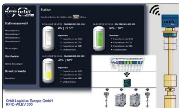
Wer Verbrauchs- und Hilfsstoffe lagern muss, kann sie mit dem neuen RFID-Füllstands- und Temperatursensor von Orbit Logistics kosten- und platzsparend verwalten. Foto: Orbit Logistics
