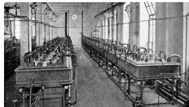
Eine wichtige Neuerung in der Gewinnung von Chlor und Hypochlorit-Bleichmitteln stellte die Zweikammer-Chloralkalelektrolyse dar, bei der Anode und Kathode in wie in dieser Anlage nach dem Billiter-System durch ein Diaphragma getrennt wurden.
