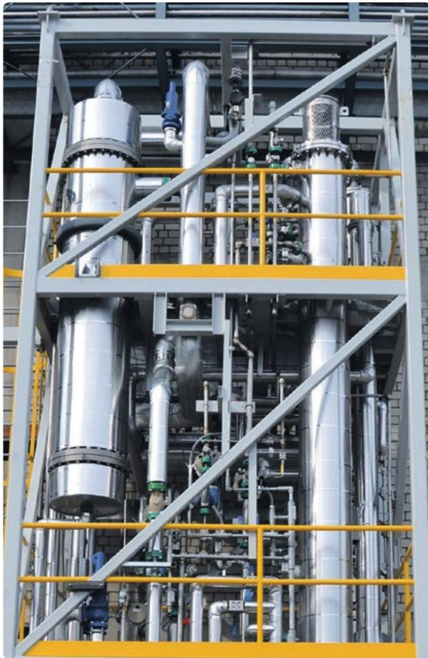
In dieser Anlage entsteht 5-Hydroxymethylfurfural aus Biomasse. Die Verbindung kann als Ausgangsstoff für viele Materialien fungieren.
