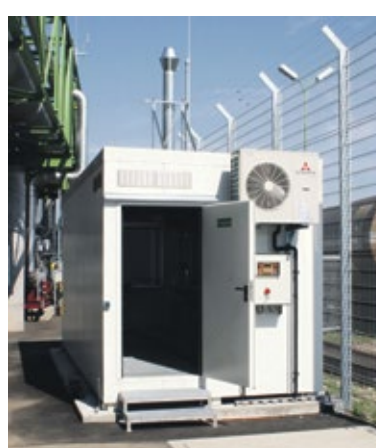
Abb. 1: Zugangsbereich des Laborcontainers mit Klimaaußengerät und Schaltschrank
