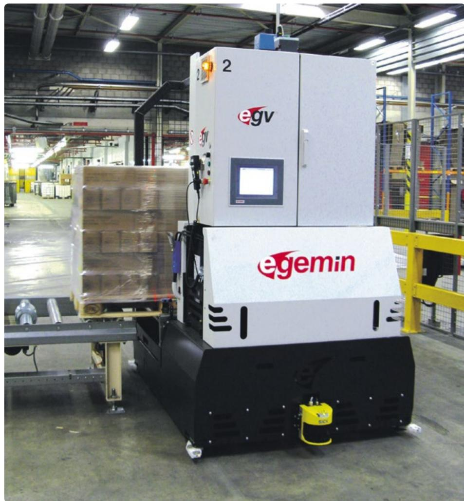
Abb. 1: Fahrerloses Transportsystem von Egemin im Einsatz bei Pfizer
