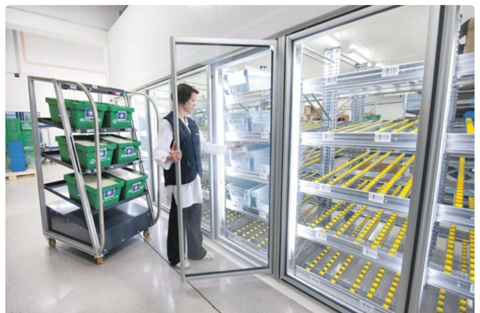
Abb. 3: Für Pharma-Produkte, die unter Kühlbedingungen gelagert werden müssen, erfolgt eine manuelle Pick-by-Light-Kommissionierung.
