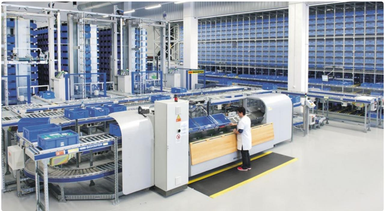
Abb. 1: Das SCS steht für hochdynamische Stückkommissionierung mit bis zu 1.000 Picks pro Stunde und Mitarbeiter.
