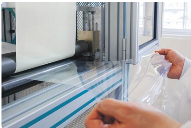
Präzisionsfolie aus Silicon: Elastosil Film ist dünner als ein menschliches Haar. Die Folie wird unter Reinraumbedingungen hergestellt und besitzt hervorragende dielektrische Eigenschaften.
