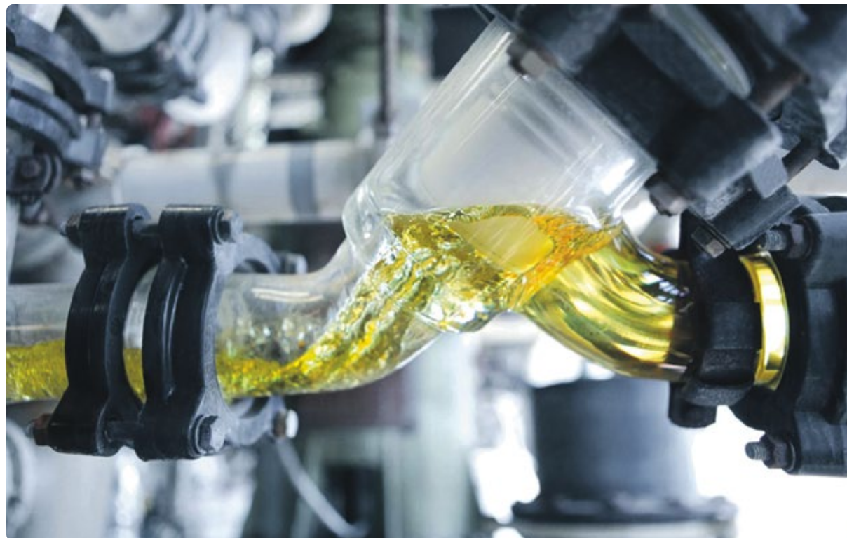
Kontroll- und Entnahmevorrichtung in einem kontinuierlichen Prozess.
