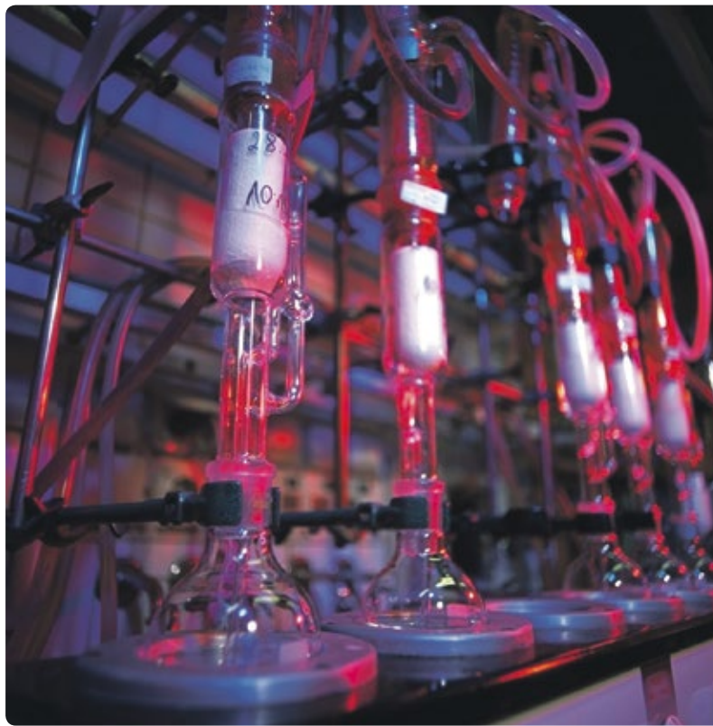
Apparaturen zur Bestimmung extrahierbarer Anteile.
