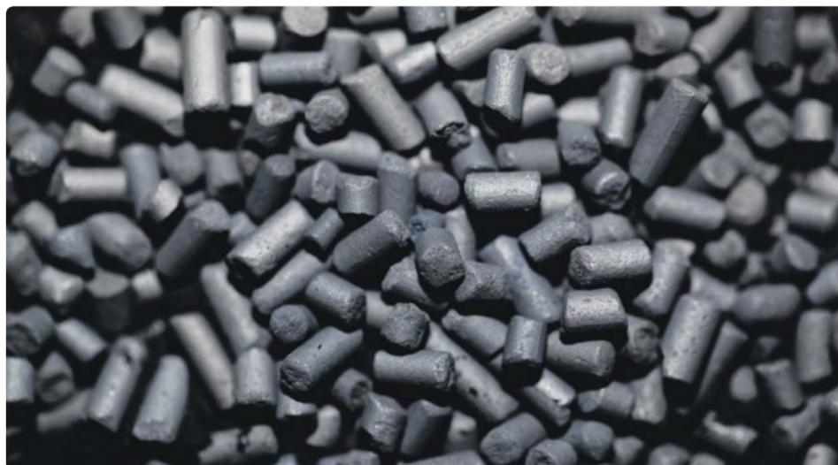
Abb. 2: Aktivkohle, die u.a. Anwendung in der Trinkwasseraufbereitung findet, wird inkl. einer kostensparenden und umweltgerechten Reaktivierung der Kohlen im Verbund mit einer innovativen Anwendungstechnik angeboten.
