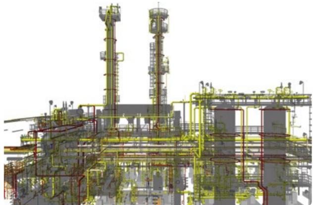
Abb. 2: Orlen Projekt: Anlagenbestandteil zur Flusssäure Alkylierung, der mit SmartPlant 3D und SmartPlant Review erstellt wurde.
