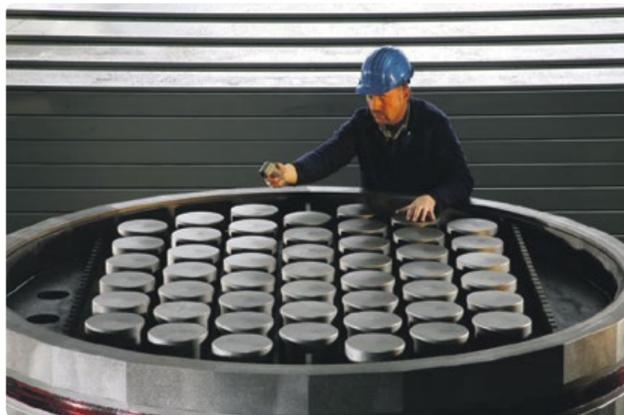
SGL hat den größten Graphit-Plattenwärmetauscher der Welt gefertigt.
