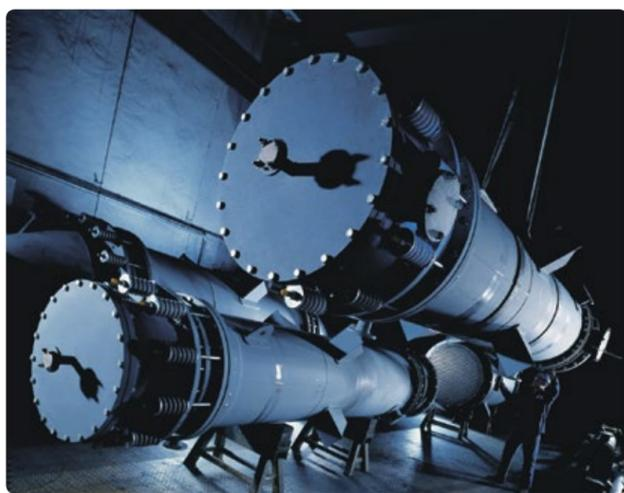
Rohrbündelwärmetauscher aus Diabon
