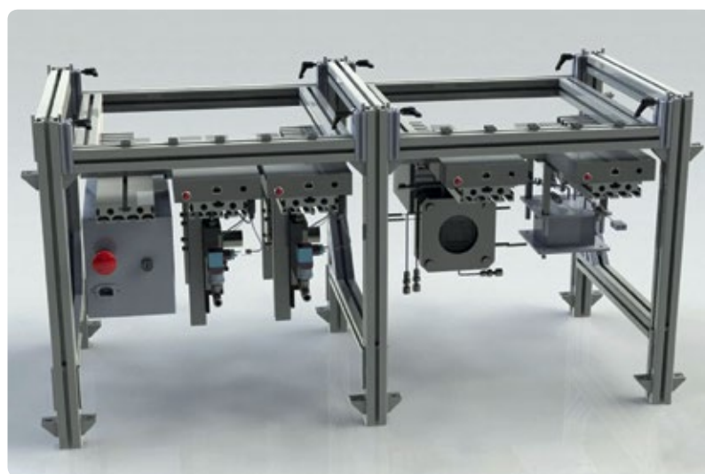
Modularer Laborreaktor-Aufbau mit Pumpen, Reaktormodul mit Schauglas, Wärmeübertrager sowie zugehöriger Mess- und Regelungstechnik. Konzeptstudie Apparatedesign, TU Dortmund.
