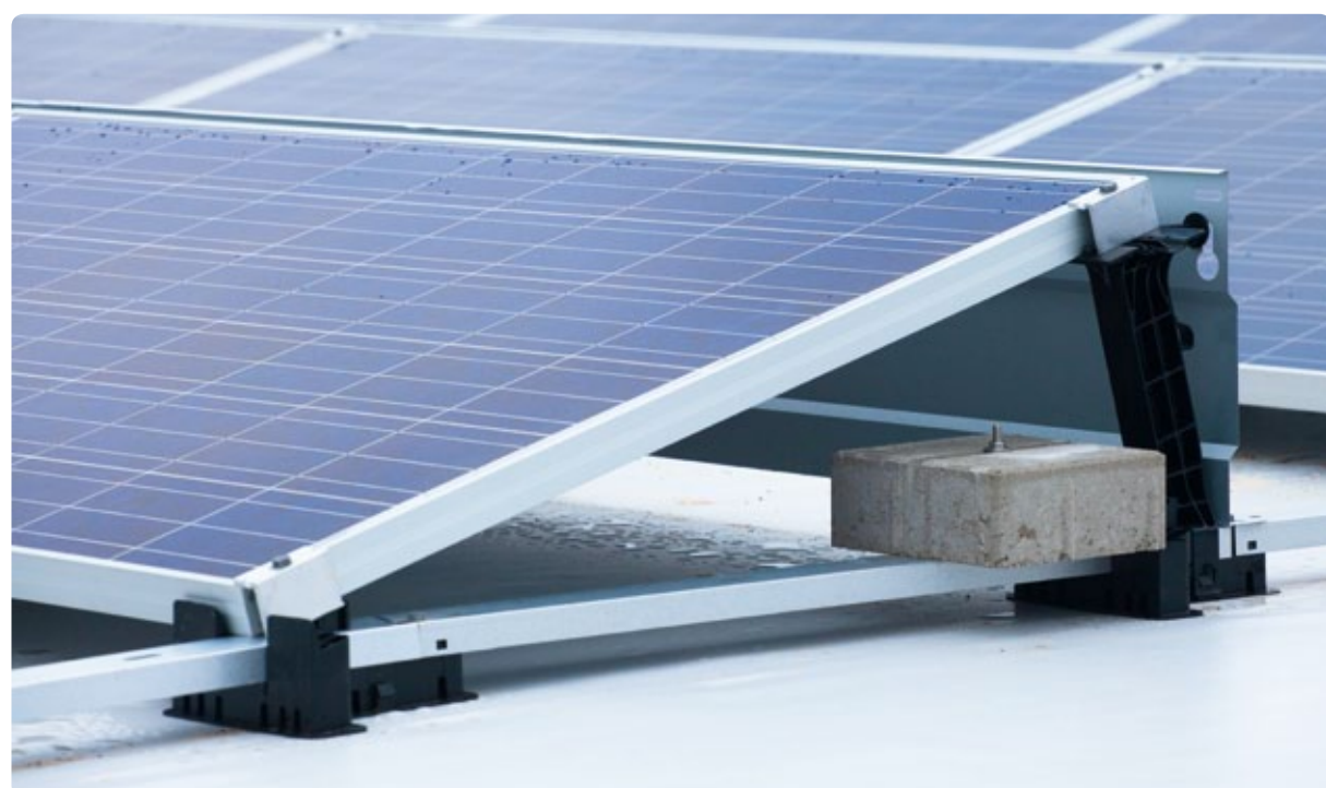
Eine neuartige Aufständerkonstruktion für Flachdach-Solaranlagen hat Goldbeck Solar zusammen mit Ensinger und der BASF entwickelt. Das leichte Montagesystem besteht aus drei Kunststoffteilen und einem Blechformteil, die im Gegensatz zu gängigen Metallsystemen sehr leicht und wetterfest sind, sich einfach montieren und fixieren lassen und die Dachhaut nicht beschädigen.
