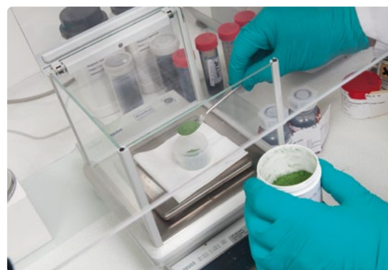
In welcher Form die zu analysierenden Produkte ankommen, spielt fast keine Rolle. Für die RFA werden die Stoffe bei Bedarf passgenau gemahlen, gepresst, geschmolzen oder auch direkt als Flüssigkeit vermessen.
