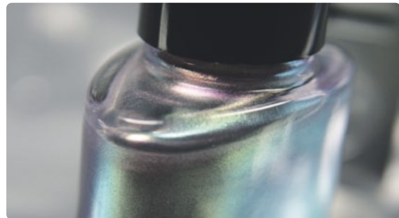
Abb. 1: Effektpigment Xirona Magic Mauve mit starkem Farbflop in einem Nagellack.
