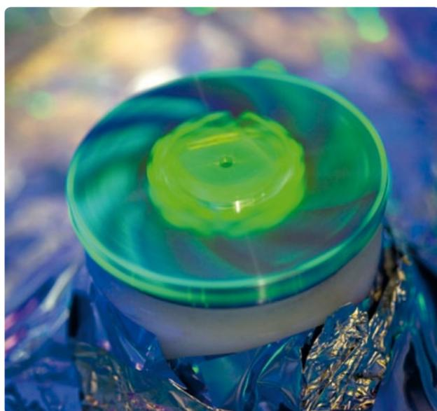
BASF forscht an Solarzellentechnologien auf Basis organischer Materialien. Hier wird ein Glassubstrat durch Spincoating mit einem für die Farbstoffsolarzelle geeigneten Materialfilm überzogen, der wenige Nanometer dünn ist.
