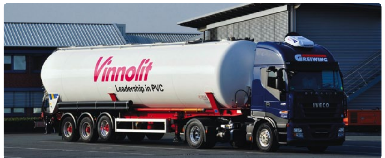
Unterschiedliche Produkte – unterschiedliche Anforderungen an die Spediteure: Für manche Kunststoffpulver sind Silo-Lkw notwendig. (© Greiving Logistics for you)
