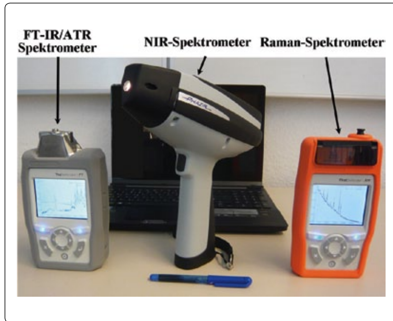
Abb. 1: Miniaturisiertes Fourier-Transform-Infrarot (FT-IR)-Spektrometer auf Basis der abgeschwächten Totalreflexion (ATR), sowie portable Nahinfrarot- und Raman-Spektrometer (© Analytikon Instruments)
