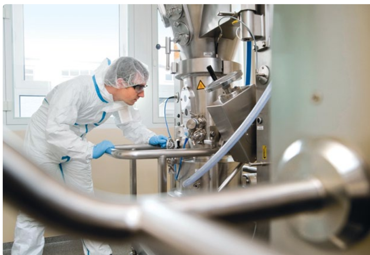
Ein Operator vor dem Wirbelschichtgerät blickt auf das bewegte Produkt – hier werden die Granulate, Pellets, Kristalle etc. überzogen.
