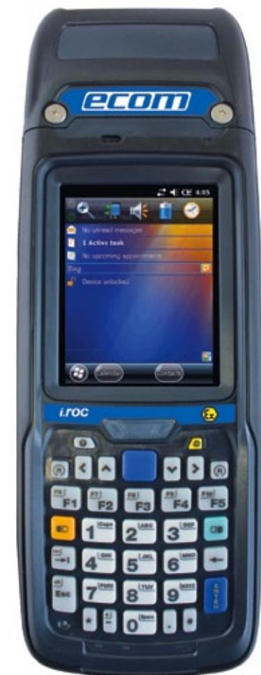
Der i.roc Ci70-Ex vereint einen stromsparenden Prozessor für lange Akkulaufzeiten mit allen aktuellen WLAN Standards für schnelle und sichere Datenübertragung und die Unterstützung von UMTS in einem Gerät.
