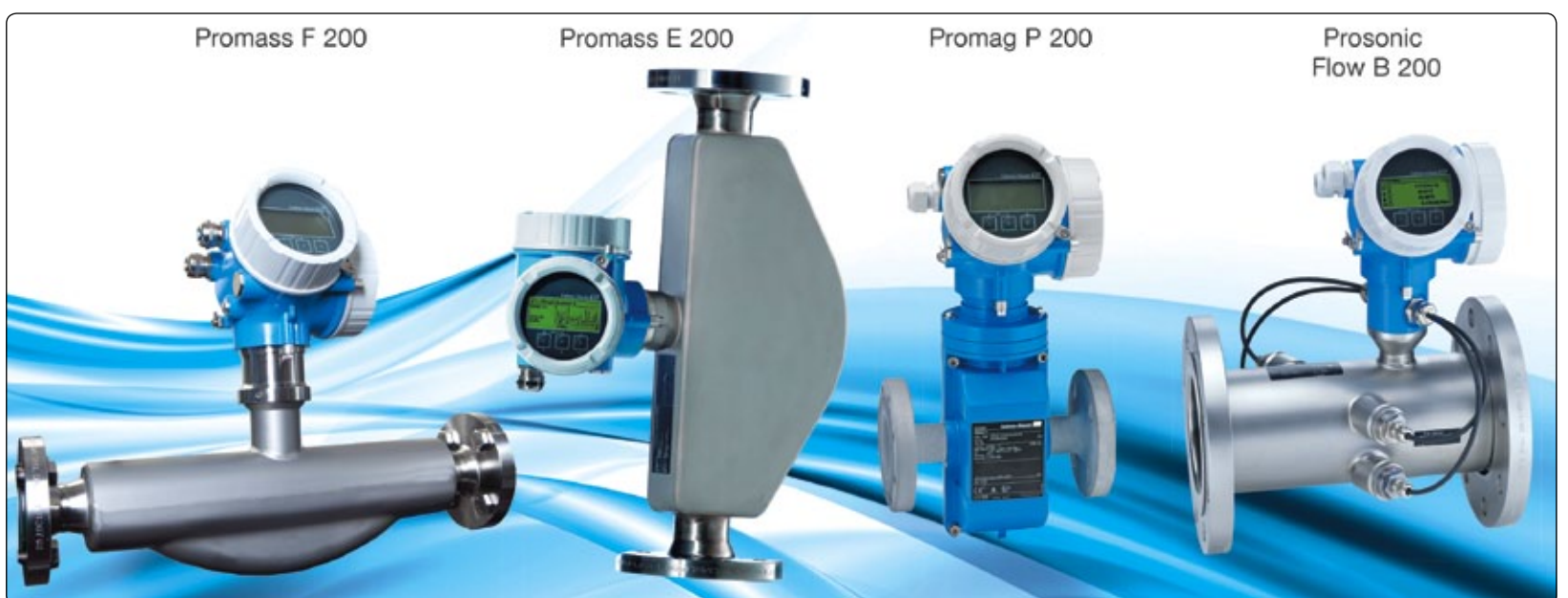
Das einheitliche Zweileiter-Konzept für Durchfluss und Füllstand erhöht die Sicherheit und senkt die Kosten. Es steht für die Durchflussmessung bei der Coriolis-Massemessung mit Promass F 200 und Promass E 200, der magnetisch-induktiven Volumenmessung mit Promag P/H 200 und der Ultraschall-Gasvolumenmessung Prosonic Flow B 200 zur Verfügung.
