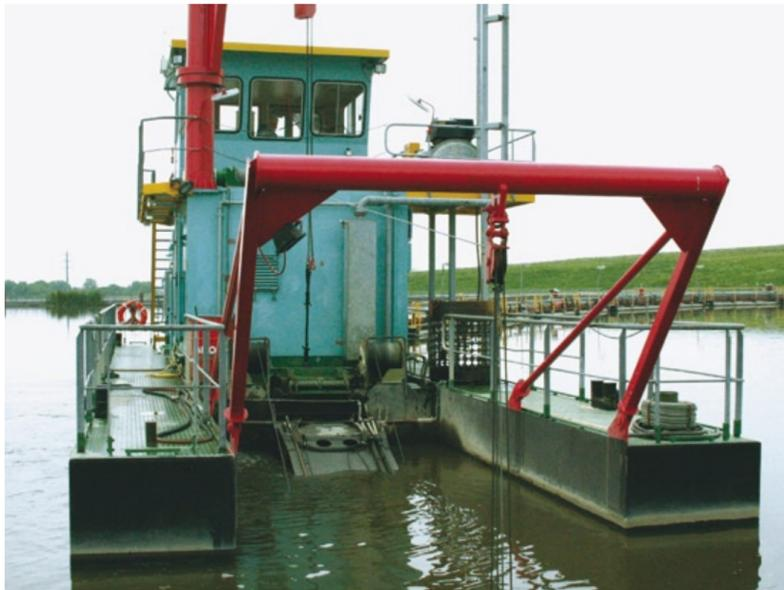
Abb. 1: Anwendungsbeispiel für eine funkbasierte Profibus-Datenübertragung mit 500 kbit/s bei einem so genannten Cutter, der Schlamm vom Boden absaugt. Dabei darf der Saugrüssel des Cutters die Abdichtfolie, die am Grund dieses Deponie-Sees liegt, nicht beschädigen. Dazu ist schnelle, verzögerungsfreie Regelung nötig.
