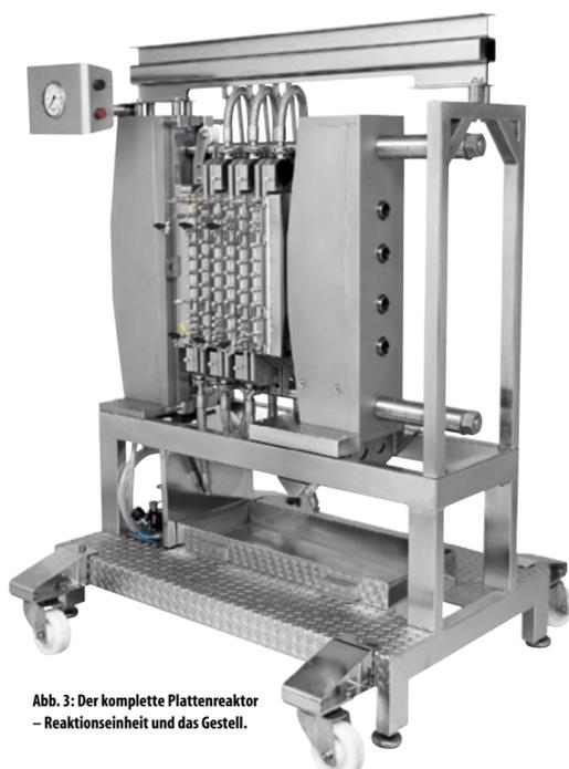
Abb. 3: Der komplette Plattenreaktor – Reaktionseinheit und das Gestell.
