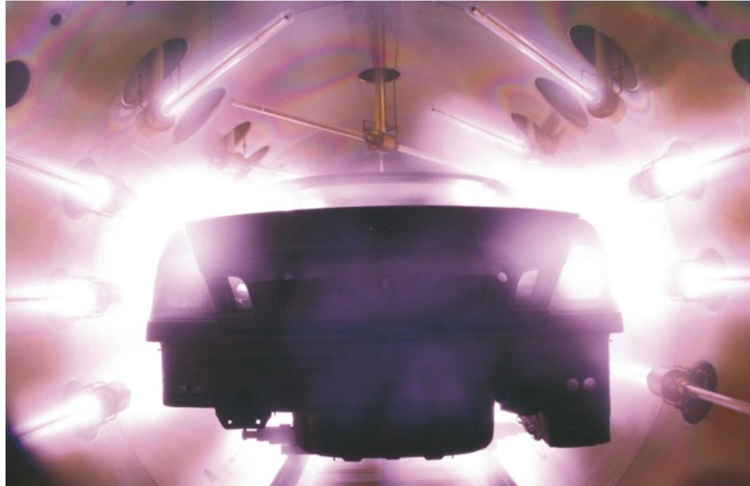
Abb. 1: Ciba nutzte die Kenntnisse der Härtung zur Entwicklung des neuartigen Plasmacure-Verfahrens, das mit Plasma als Lichtquelle das Problem der Schattenzonen eliminiert.
