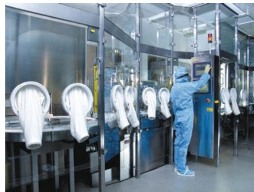
Abb. 2: Passives Containment-RABS auf einer Ampullen-Abfülllinie. Containment Systeme arbeiten mit einer geschlossenen Luftzirkulation, bei der keine Abluft in den Umgebungsraum abströmen kann.
