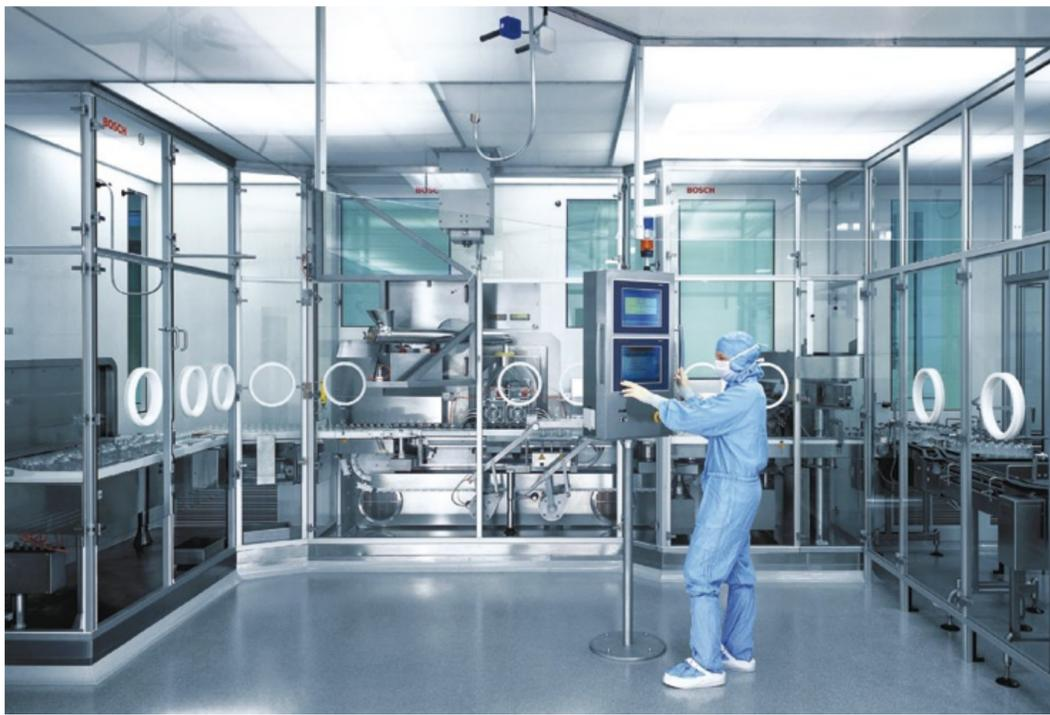
Abb. 1: Pulverabfülllinie mit passivem RABS. Passiv oder aktiv bezieht sich dabei auf die Luftaufbereitung.
