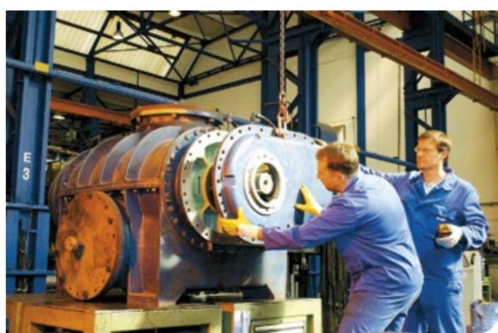
„In der richtigen Strategie, einer Mischung aus vorbeugender, ausfallorientierter oder risikobasierter Instandhaltung, liegt der Schlüssel zur Kostensenkung“, sagt Heinz Hefele, Leiter des Fachreferates Maschinentechnik und des Fachzentrums Rotating Equipment der BASF. Im Bild: Montage eines Drehkolbengebläses nach der Instandsetzung.
