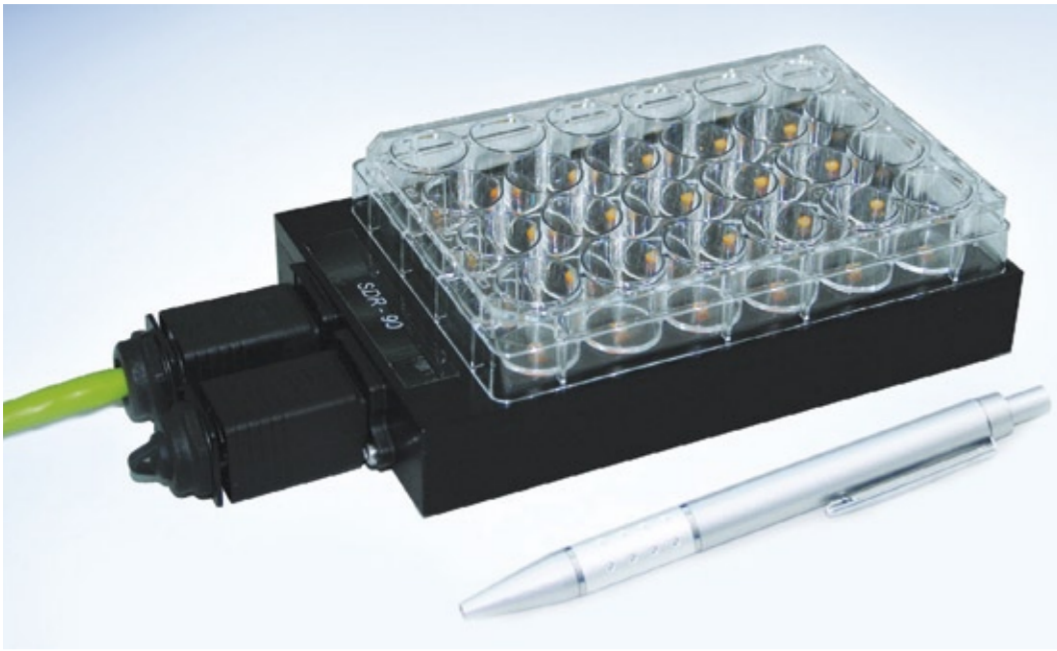
SDR Sensordish Reader mit Sensordish zum kontinuierlichen Online-Monitoring von Sauerstoff oder pH-Wert im Brutschrank. Bis zu 10 solcher Reader lassen sich verbinden und mit einer Software kontrollieren.
