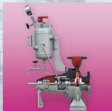
Spiralgehäusepumpen NCL (EN 79405) mit doppelwirkender Gleitringdichtung und Thermosiphonbehälter
