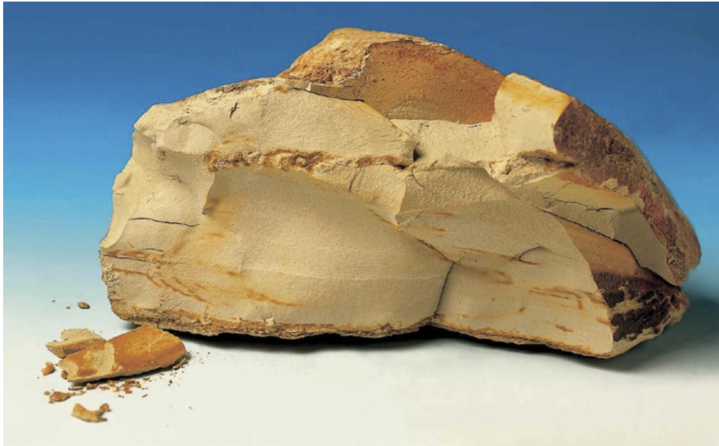
Abb. 1: Die Produkte der Süd-Chemie basieren stark auf natürlichen Tonmineral Bentonit und seinem wichtigsten Inhaltsstoff, dem Montmorillonit, ein Schichtsilikat. Aufgrund seiner Hohlräume bzw. Quellfähigkeit verfügt dieses Mineral über eine große innere Oberfläche, die es nach entsprechender Verarbeitung für Adsorptionsprozesse z. B. der Reinigung von Flüssigkeiten oder auch als Trägermaterial für katalytische Reaktionen geeignet macht.
