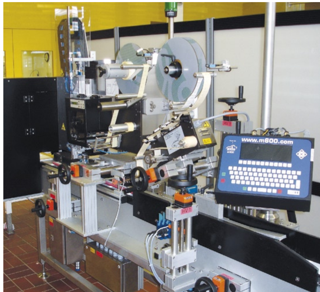
Abb. 1: Die beiden neuen Etikettier- und Bedruckungsstationen für Faltschachteln bei Biotest. Die etikettierten und bedruckten Faltschachteln werden durch ein nachgelagertes, vollautomatisches Bildverarbeitungssystem von VMT Bildverarbeitungssysteme im Durchlauf überprüft. Diese Kontrollstation ist in dem schwarzen Kasten auf der linken Bildseite untergebracht.
