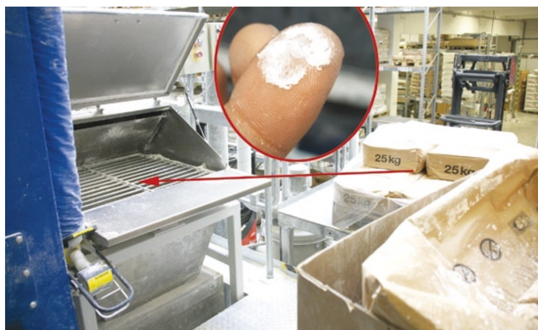
Abb. 4: Früher wurde das TiO 2 -Pulver in 25 kg-Papiersäcken bezogen. Die Mitarbeiter in der entsprechenden Abteilung waren täglich rund 1,5-2 Stunden nur damit beschäftigt, Säcke aufzureißen und in den Fülltrichter zu entleeren.
