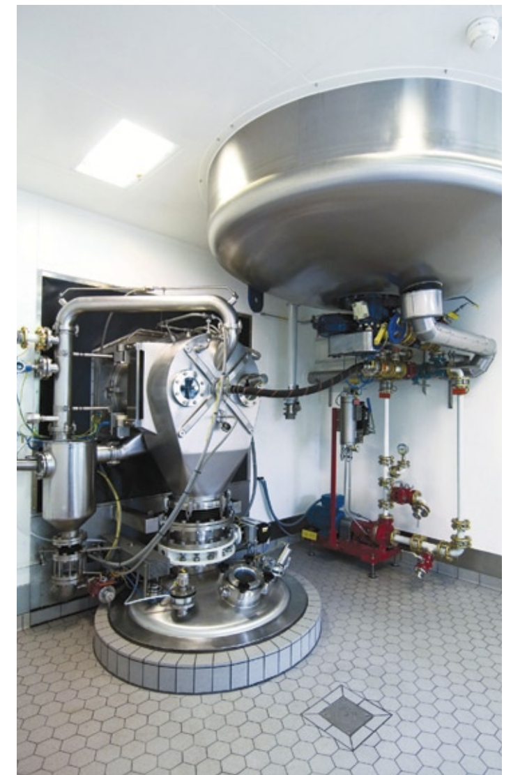
Blick ins Innere der erweiterten Wirkstoffproduktion – Zentrifuge zur Feststoffisolierung – bei Degussa im Industriepark Wolfgang.
