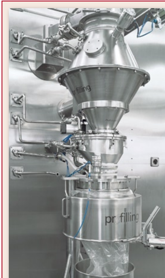
Abb. 1: Bei einem führenden Pharmaproduzenten hat Frewitt dessen Transport- und Abfüllanlagen für pulverförmige Wirkstoffe zu einem geschlossenen Ablauf unter Reinraumbedingungen zusammengefasst.
