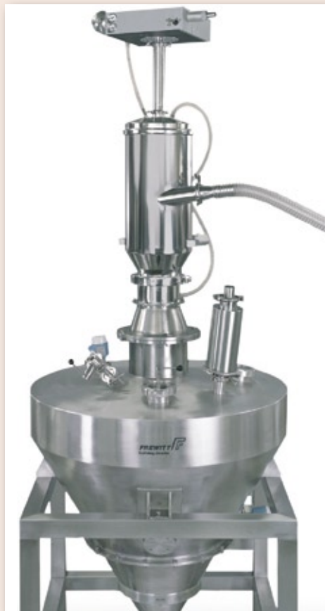
Abb. 2: Für den Transport zwischen Zentrifuge und Entleerstation kommen absolut dichte, 1.000 l fassende Container zum Einsatz.
