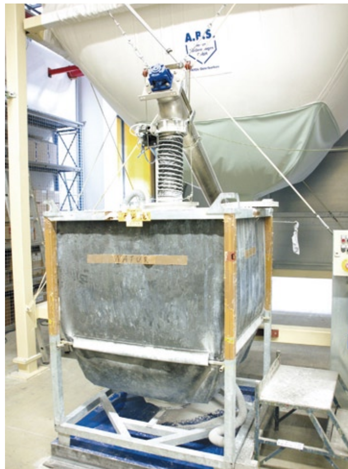
Abb. 2: Der Materialabzug vom Silo in den Transportcontainer erfolgt automatisch mittels Förderschnecke, die Dosierung wird per Waage kontrolliert.
