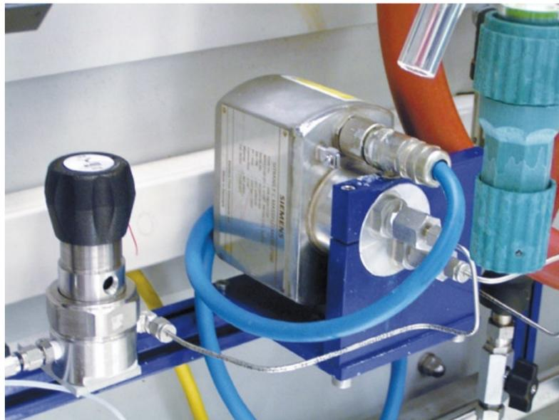
Der speziell für diese Anwendung konzipierte Messaufnehmer von Siemens ist in das Mikroreaktions-Skid bei Merck eingebaut. Zu beachten sind die Edelstahl-Prozessleitungen mit 1,5 mm Durchmesser
