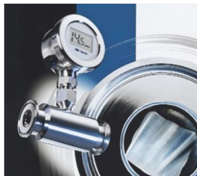
messsysteme, wie z.B. Manometer, Druckmessumformer oder Druckschalter an einen Rohrdruckmittler angebaut werden. Die Druckübertragung erfolgt über das Membranrohr mittels einer dahinter befindlichen mediumgerechten Druckübertragungsflüssigkeit direkt auf das ausgewählte Druckmesssystem.
