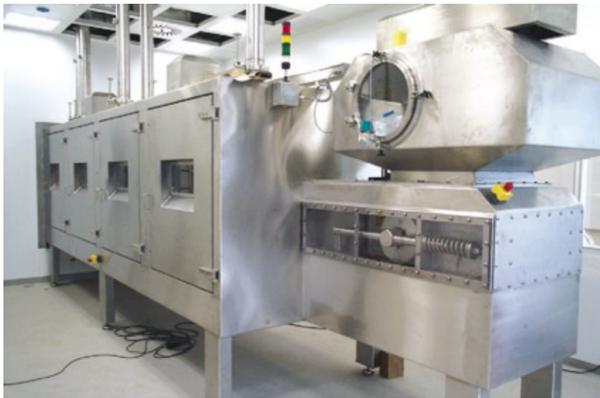
Heinen Drying hat eine Bandrocknungsanlage zur kontinuierlichen Trocknung und Konditionierung von wirkstoffhaltigen Hartgelatine-kapseln entwickelt. Die Anlage wurde auf die Anforderungen des Produktes abgestimmt, um die temperaturrempfindlichen Kapseln auf die genaue Endfeuchte abzutrocknen. Zu den Besonderheiten des Pharma-Bandrockners zählt ein kontinuierlicher vollautomatischer Betrieb. Das System wurde einschließlich Steuerung in enger Kooperation mit Kunden
