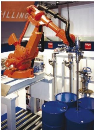
Der Robotfiller befüllt Kanister, Eimer, Fässer und IBCs in der Größe von 10 - 1.000 kg, die als Einzelgebinde auf der Rollenbahn oder im Verbund auf der Palette transportiert werden. Im Bild die so genannte Portalversion, d.h. Arbeitsposition des Roboters auf einem Portal über dem Transportsystem.
