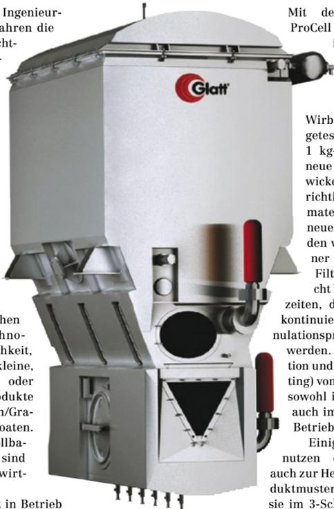
Die Strahlschicht-Technologie von Glatt erlaubt eine kontinuierliche Prozessführung zum Sprühgranulieren, Agglomerieren, Coaten (Filmcoaten; Lipid-/Hot-Melt-Coaten), Verkapseln von Flüssigkeiten, Trocknen und Sprühtrocknen auf Inertkörper. Im Bild eine Procell 125-Strahlschichtanlage.
