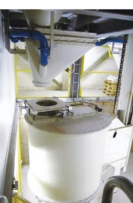
den, durch die eine genaue Dosierung und Prüfung der vollständigen Entleerung stattfindet. Behälter und Andockstation sind so konzipiert, dass kein Staub nach außen dringt. Auf dem Weg zu einem oder mehreren Befüll- und Abgabepunkten ist der Behälter vollständig geschlossen.
