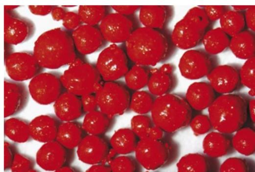
Produktfoto eines Vitamins als Beispiel für die Sprühgranulation von Flüssigkeiten mit der Procell-Strahlschicht-Technologie.
