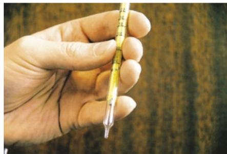
Abb. 2: Die gläsernen, beidseitig verschlossenen Detektorröhrchen sind mit unterschiedlichen Reagenzien gefüllt.
