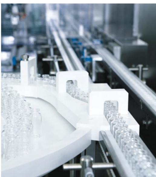
Die Vialzuführung für die aseptische Abfüllung in der neuen Produktionsstätte RVS.
