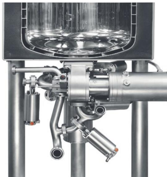
Ekato Systems präsentiert auf der Powtech den Rotor-Stator-Homogenisator Versatile Jet
