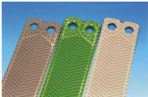
Die Antihafbeschichtung von Wärmetauscherbleche mit organischen Fluorpolymeren (FEP, MFA, PFA) sorgt für nahezu konstante Prozessbedingungen. Leistungsbeeinträchtigungen durch Produktanbackungen, Ablagerungen und Biofouling können so vermieden werden.
