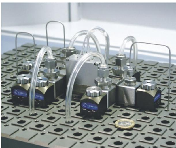
Modulares Mikroreaktionssystem – hier zur Entwicklung im Labormaßstab. Lonza untersuchte bei 22 Flüssigphasenreaktionen, die bislang durch Batch- oder Semibatchprozesse realisiert werden, ob sich diese auch für eine mikroreaktionstechnische Produktionsweise eignen. Dabei zeigte sich, dass sich davon 50 % für ein derartiges, kontinuierliches Verfahren eignen würden. (Foto: Ehrfeld Mikrotechnik BTS).
