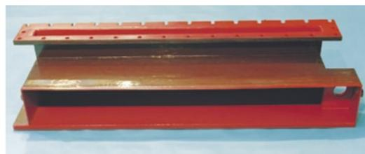
Beschichtungen auf Basis von Fluorpolymeren wie E-CTFE, FEP, MFA und PFA werden u.a. als passiver Korrosionsschutz eingesetzt. Mit einer PFA-Beschichtung konnte bei Einlaufwehren ein wirtschaftlicher Vorteil von rund 20% erzielt werden.
