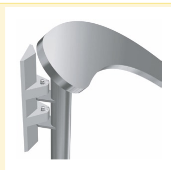
Abb. 4: Die Abstreifer des Ekato Paravisc-Systems minimieren Wandgrenzschichten.
