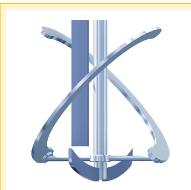
Abb. 2: Durch den Einsatz eines innen liegenden Stromstörers kann der wandgängige Ekato Paravisc Rührer auch bei niedrigviskosen Medien eine gute axiale Mischkomponente erzielen. Exzentrische Zusatzrührwerke sind ebenfalls einfach adaptierbar.
