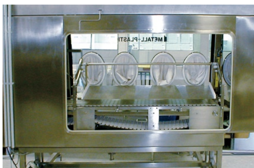
Abb. 2: Isolator für die Gefriertrocknerentladung
