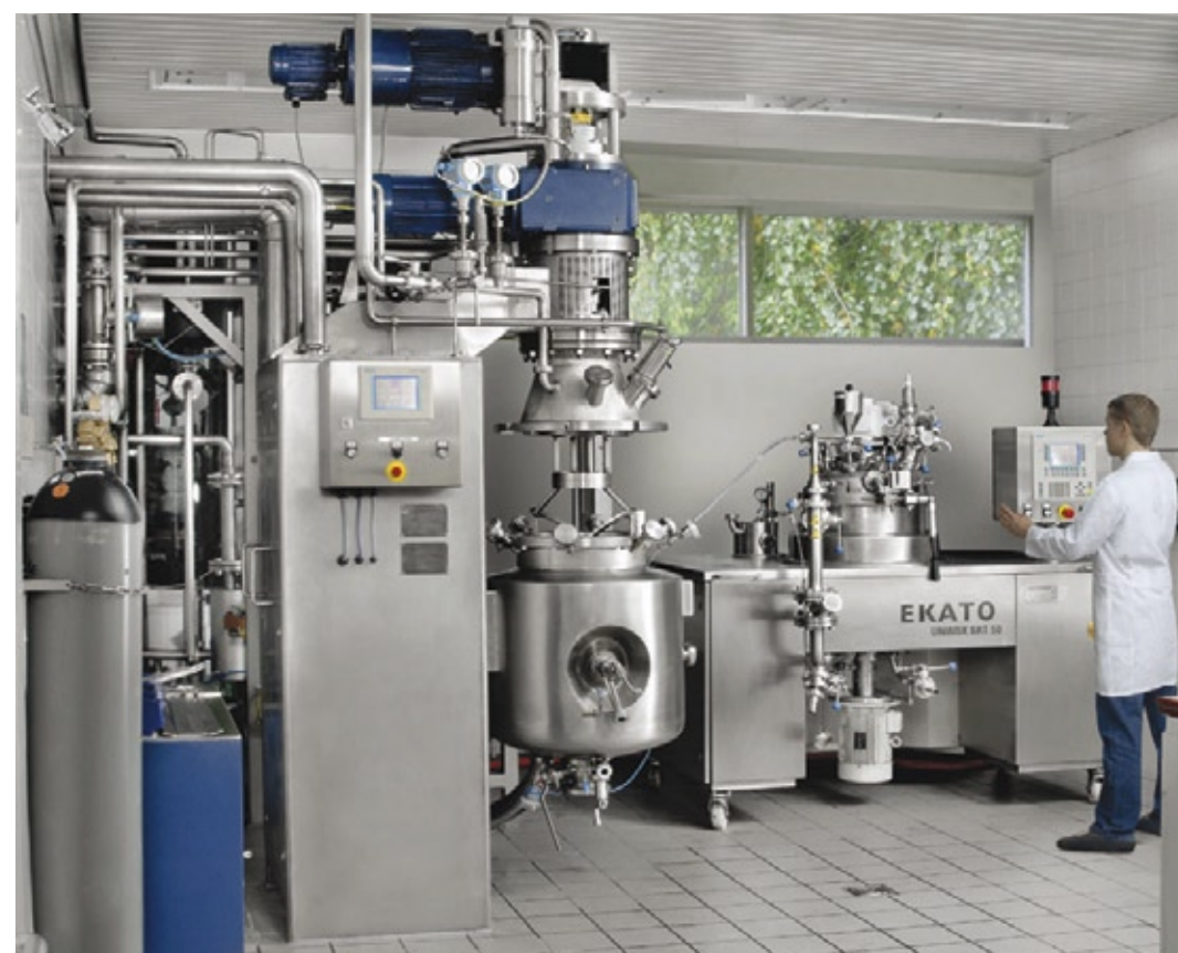
Abb. 1: Ausschnitt aus dem Ekato Technikum: Komplexe Batchprozesse können oft nur auf Basis von Versuchen zuverlässig ausgelegt werden.
