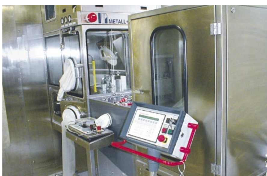
Abb. 1: Bördelmaschine im Isolator mit anschließender Vials-Außenreinigungsmaschine
