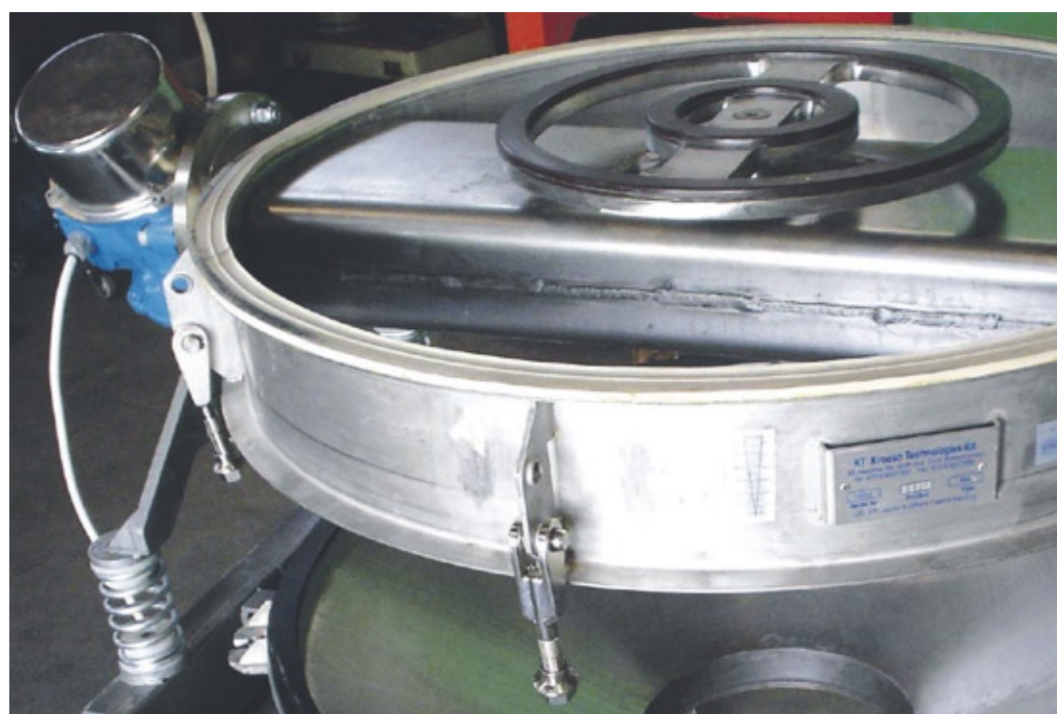
Blick in eine Vibrationsmaschine mit einem eingebautem Vibrationsanpassungssystem, dem so genannten „Kroosher“. Der Kroosher besteht aus mehreren rein mechanischen Bauteilen wie Resonanzringen oder Stangen und „verwandelt“ die Vibrationseinzelfrequenz in eine starke multifrequente Vibration. Somit benötigt der Kroosher also keine zusätzliche Energiezufuhr.
