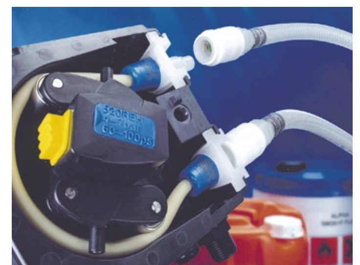
Abb. 5: Blick in eine Schlauchpumpe von Watson-Marlow mit der Schlauchbefestigung
