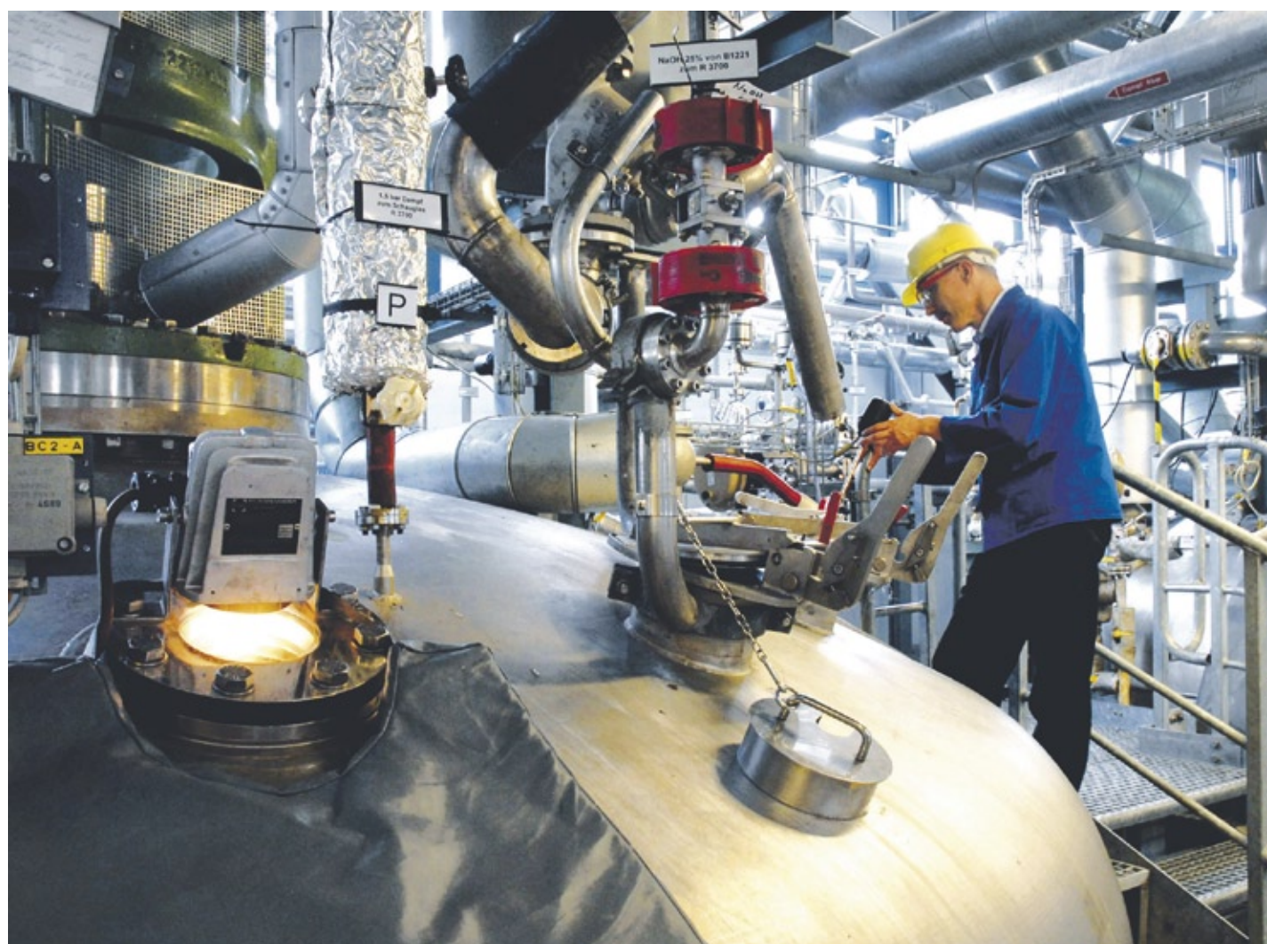
Biotechnologische Produktion des Enzyms Phytase mithilfe des Schimmelpilzes Aspergillus niger bei der BASF in Ludwigshafen. Dieses Enzym wird dem Futter für Schweine und Geflügel zugesetzt, damit die Tiere das in der pflanzlichen Nahrung enthaltene Phosphat besser verwerten und nutzen können. Dadurch muss dem Tierfutter deutlich weniger Phosphat in anorganischer Form zugesetzt werden. Zudem wird die Menge des mit der Gülle ausgeschiedenen Phosphats vermindert, wodurch Böden und Gewässer um etwa ein Drittel weniger belastet werden.
