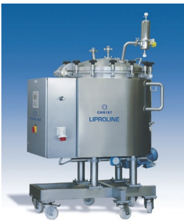
Mit der Liproline-Reihe bietet Christ alle Komponenten, die für eine pharmazeutische Fertigung nötig sind, aus einer Hand. Die Ansatzbehälter beispielsweise werden auf 3D-CAD-Basis geplant und ermöglichen gemeinsam mit einem Prozessleitsystem eine rezeptbasierte Fahrweise mit automatischer Batch-Protokollierung. (Fotos: Christ Water Technology Group)
