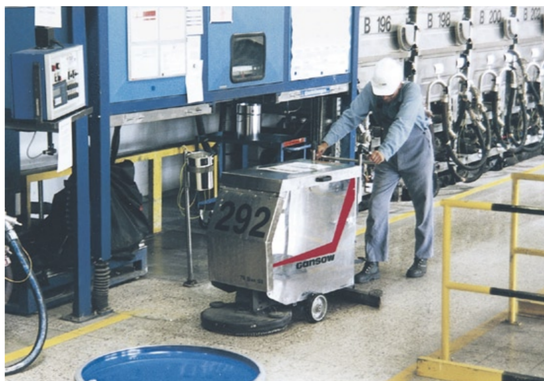
Wöchentlich werden die Fußböden in den Bereichen Abfüllung und Verpackung bei BASF Coatings in Münster gereinigt. Weil dort mit Lösemitteln und teilweise offenen Gebinden hantiert wird, müssen auch die Reinigungsmaschinen wie diese Scheuersaugmaschine von IP Gansow explosionsgeschützt sein. (Foto: IP Gansow)
