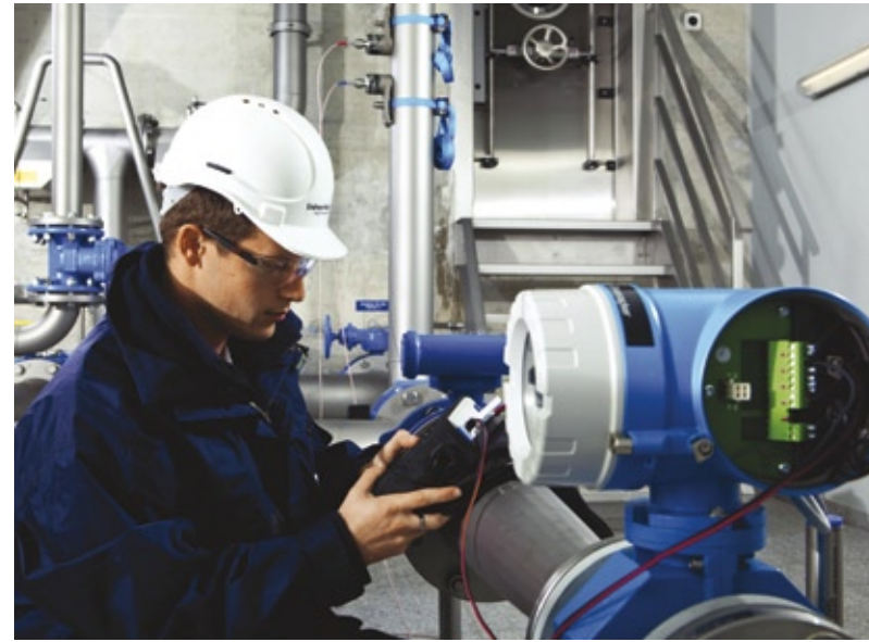
Abb. 3: Mit dem Verifikationstool FieldCheck können alle Sensoren und Messumformer der Proline Durchflussmessgeräte ohne Ausbau vollumfänglich überprüft werden
