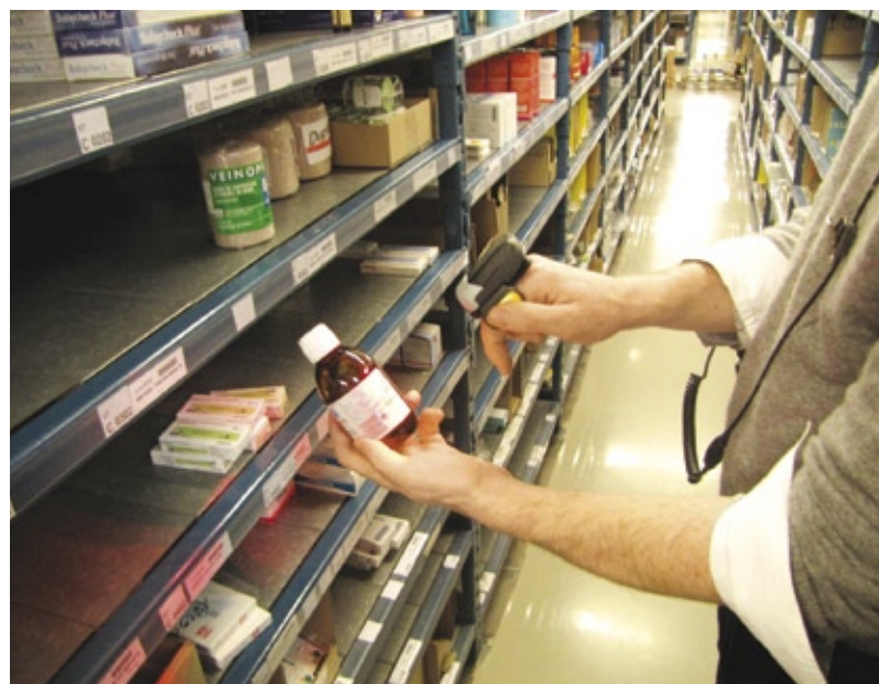
Im Cep-Lager wird jedes Produkt mit einem tragbaren Ringscanner erfasst, der die Datamatrix-Codes ausliest.
