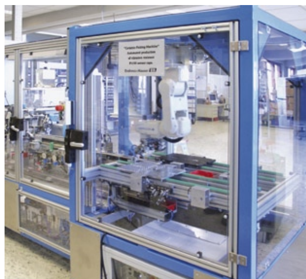
Automat für die Fertigung der Sensorkappen
