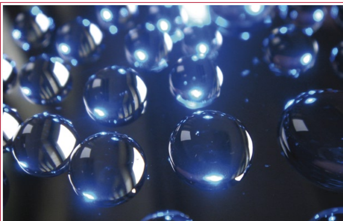
„Weihnachtsbaumkugeln“: Wassertropfen auf hydrophober Chromoberfläche. (C) Stefan Sepeur, Nano-X GmbH/NanoBioNet
