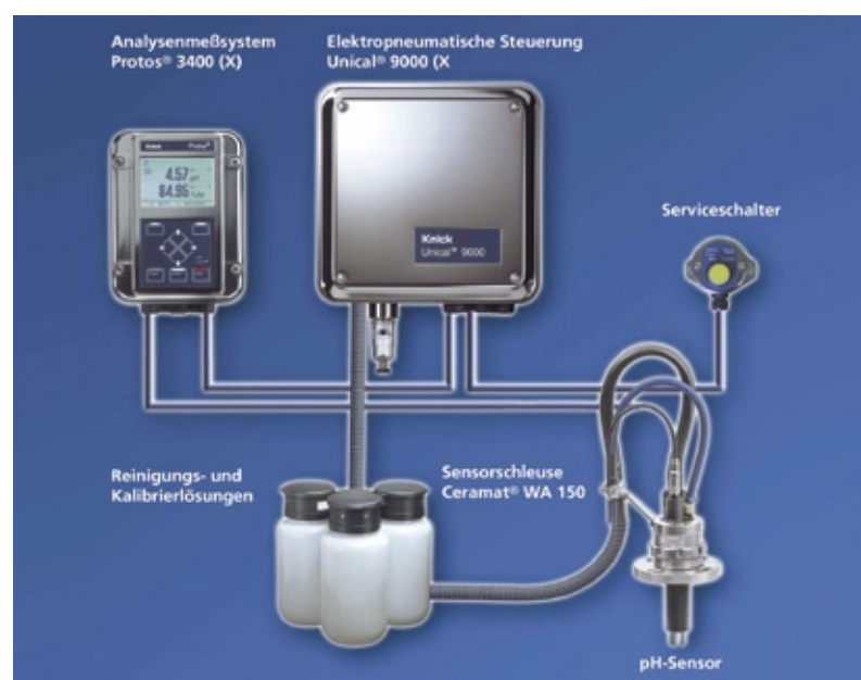
Das komplette System mit dem Analysenmesssystem Protos, der elektro-pneumatischen Steuerung Unical, der Sensorschleuse Ceramat und dem pH-Sensor vereint hohe Verfügbarkeit, optimale Prozessführung und niedrige Cost of Ownership.
