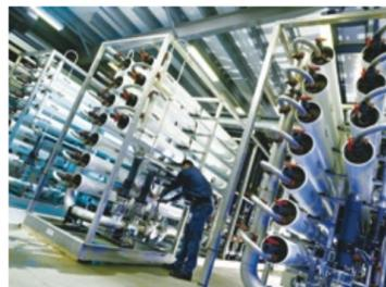
Membranfiltrationsanlage mit Umkehrosmosemembran zur Aufbereitung des Ablaufs einer kommunalen Kläranlage
